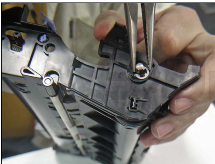
19. Extraer el eje del cilindro.
