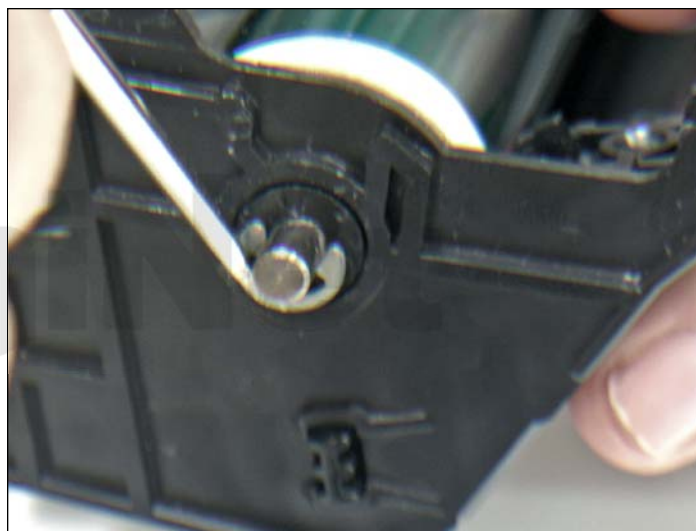
18. Extraer el eje del cilindro soltando la arandela de seguridad del lado izquierdo
