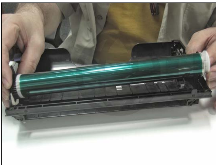
21. Al quedar el cilindro suelto también lo harán la brida y el resorte de la derecha y el engranaje impulsor de la izquierda.
