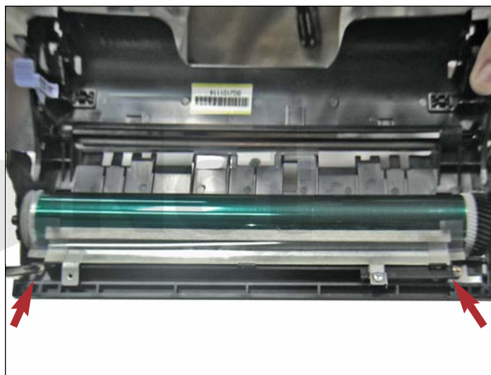
16. Usar un desarmador Phillips y retirar los dos tornillos que sujetan el ensamble de limpieza del cilindro. Se notara que esta compuesto de un fieltro de limpieza, lamina de recuperación y dos raspadores.
