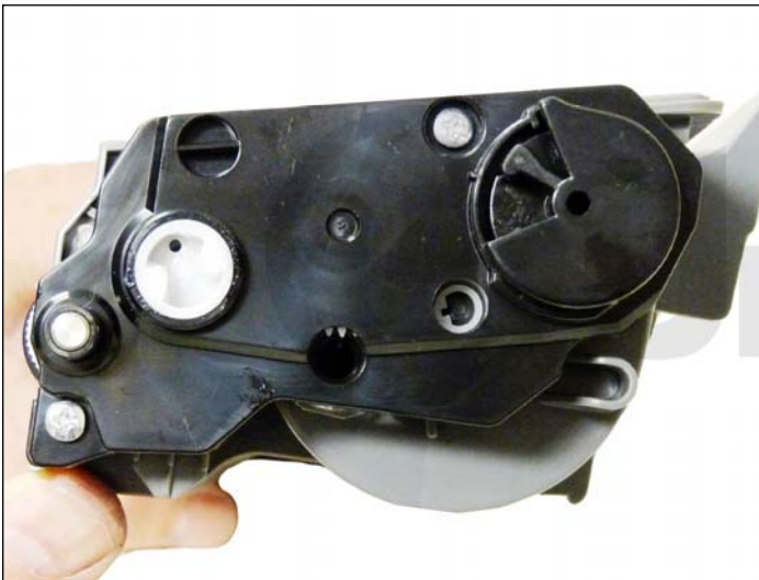
16. Instale la placa de la cubierta del engranaje y los dos tornillos para el TN620 .
