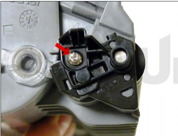
17. En el lado de no engranaje, instale la placa del eje de la cubierta exterior y atornille.
