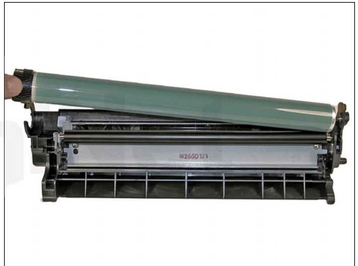
7. En la sección de desperdicio del cilindro, remueva el cilindro.
