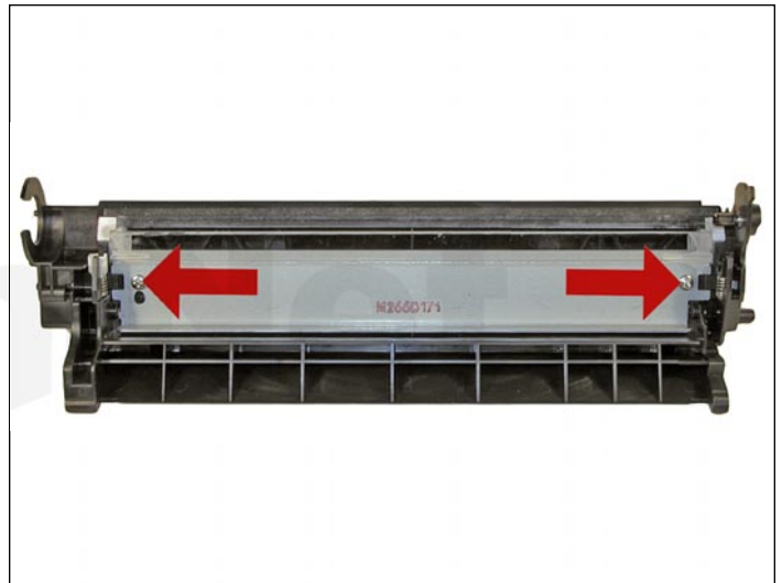
9. Remueva los dos tornillos y la cuchilla limpiadora.
