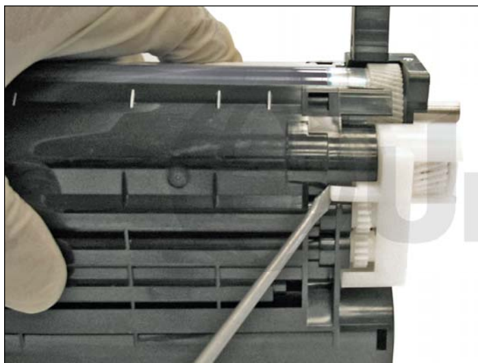
4. Remueva la cubierta lateral blanca liberando el seguro en forma de clip.
