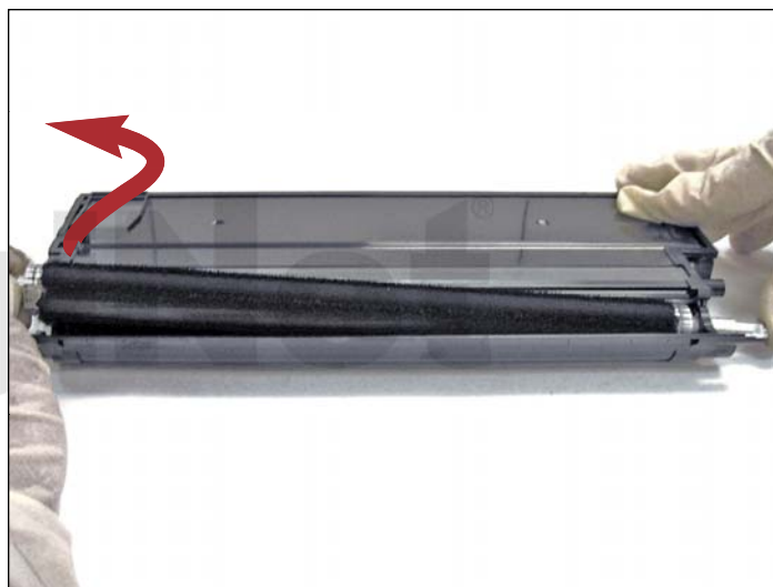
13. La manera más rápida de remover el buje de soporte en el lado opuesto es levantar primero el rodillo magnético. Hálo cerca de 5 mm después deténgase y posicione el rodillo magnético de nuevo en el cartucho.
