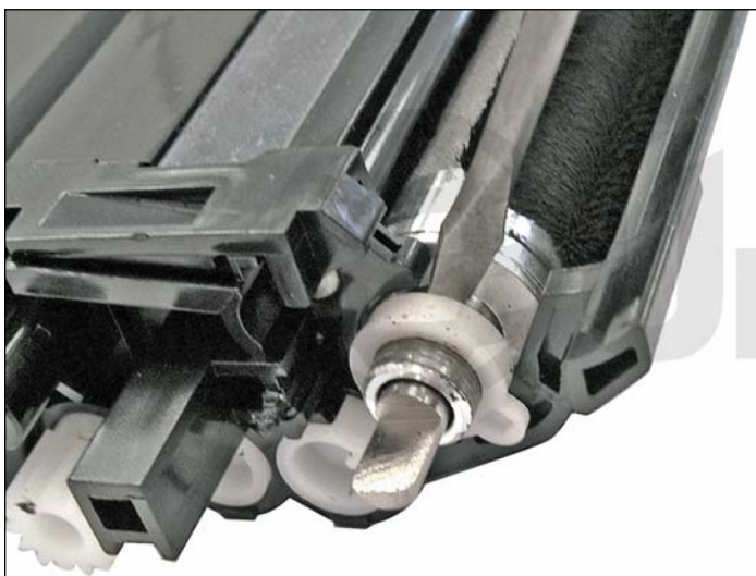
12. Remueva el soporte de los bujes del rodillo magnético.
