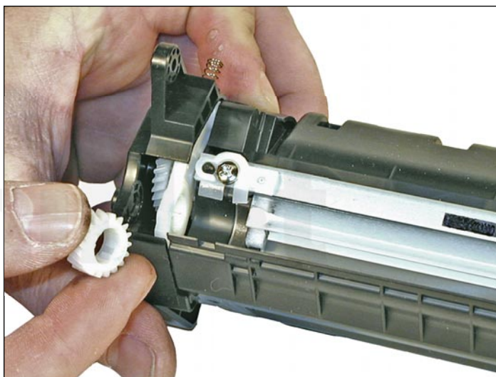
15. Remueva el engranaje guía del rodillo magnético y los bujes si no salen junto con el rodillo.
