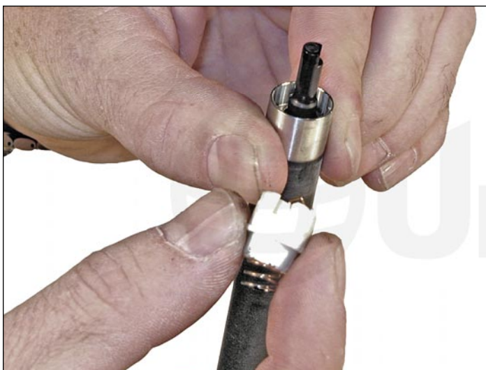
16. Reemplace la manga o camisa del rodillo magnético es una tarea sencilla. Sólo presione el imán y la cavidad de plástico se liberará.
