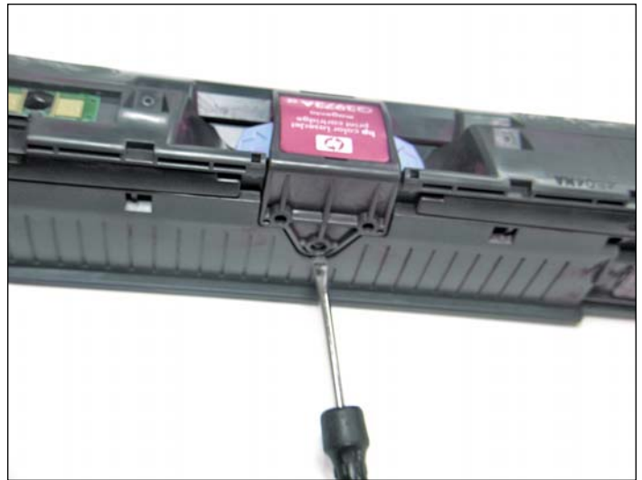
12. Com ajuda de chave de fenda comum pequena retirar as travas da capa da lâmina como se mostra.
