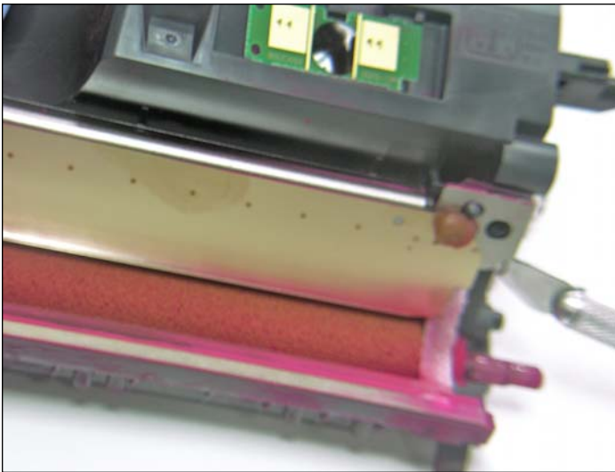
15. Com um estilete abrir cuidadosamente o adesivo da espuma atrás da lâmina dosificadora que a fixa ao plástico do cartucho.
