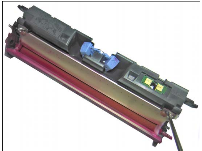
14. Desparafusar os dois parafusos que fixam a lâmina na sua posição, como se mostra.
