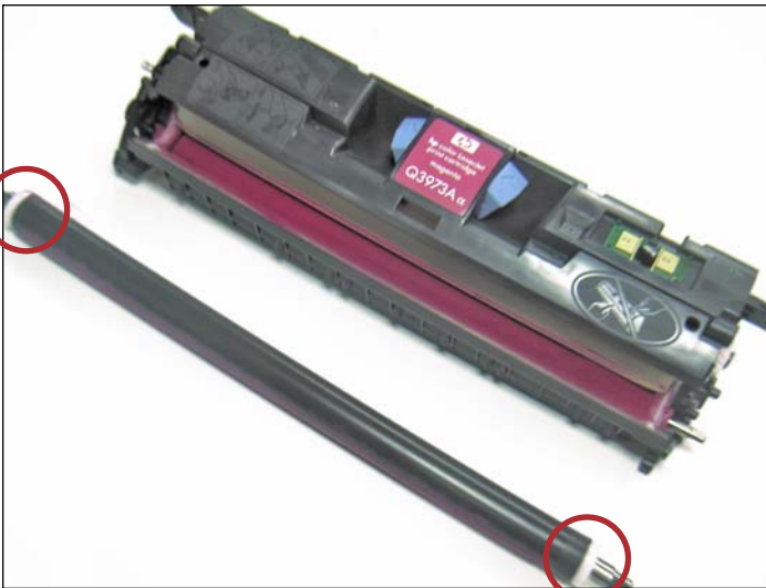
11. No perder los bujes blancos ubicados en cada extremo del rodillo.
