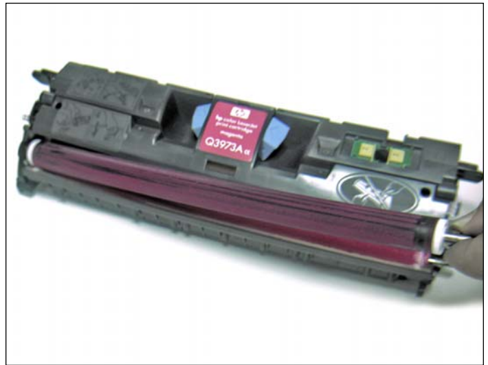
10. Sacar el rodillo de revelación como se muestra.
