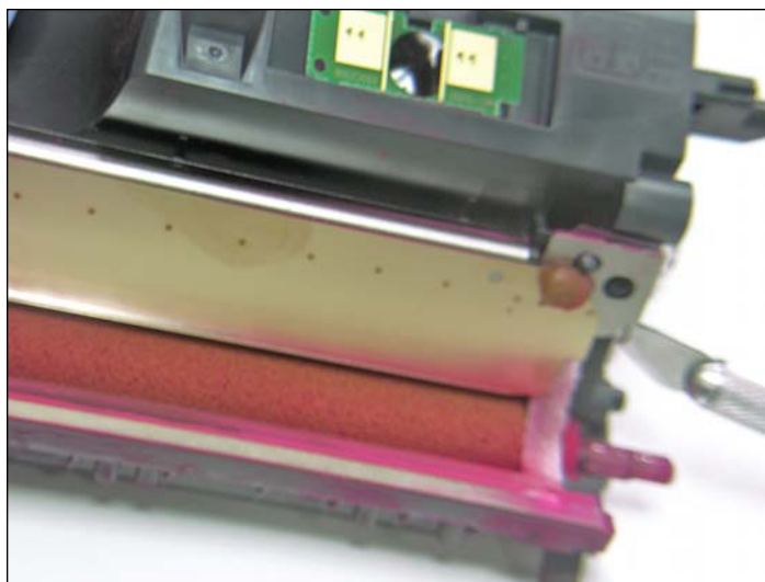
15. Con una hoja de cuchilla fina cortar cuidadosamente el adhesivo detrás de la cuchilla dosificadora que la mantiene pegada a la estructura del cartucho.
