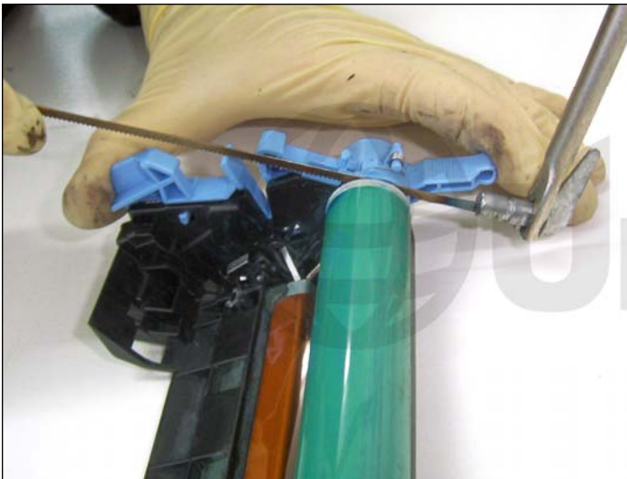
14. Cuidadosamente corte el eje de plástico blanco y deténgase cuando llegue a la mitad. No cerruche completamente.
