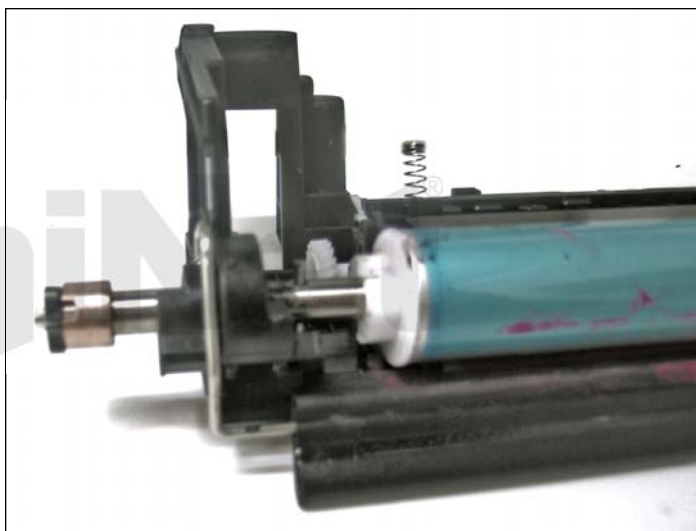
26. Deje el buje colgar del borde como se muestra.
