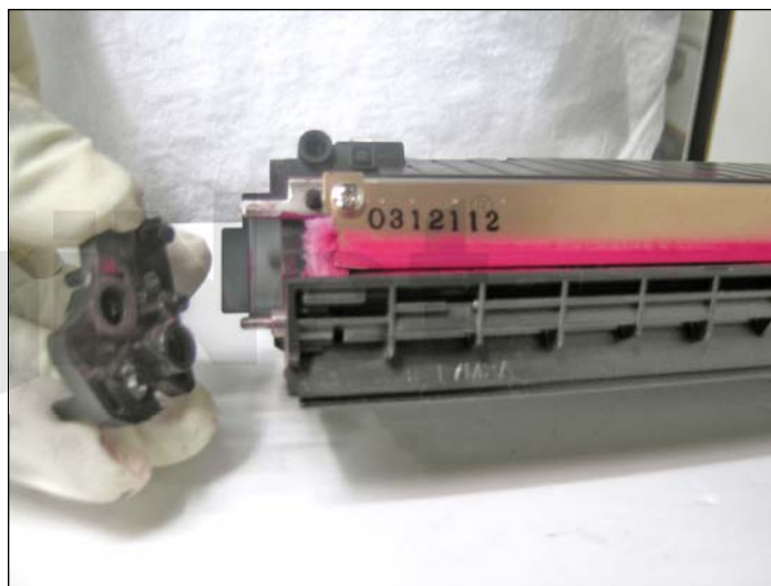
14. Extraer los dos tornillos del lado opuesto para retirar el soporte.
