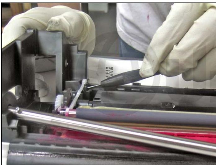
29. Sacar el rodillo PCR destrabando ambos lados como se muestra.
