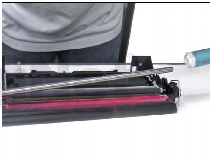
28. Deslize el cilindro como se muestra.
