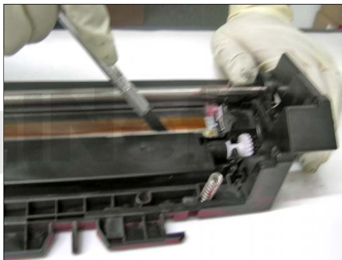
31. Para retirar la cuchilla de limpieza, cortar el adhesivo original de fabrica para poder sacar la cuchilla.
