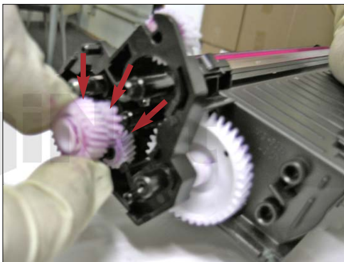
11. Retirar los tres engranajes interiores.
