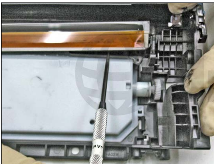
34. Calzar un destornillador fino entre la base de la cuchilla y el cuerpo para hacer palanca. Ayudar con un escalpelo el corte del adhesivo sellador color gris. Posicionar el destornillador sobre la tolva de desperdicios para apoyar y efectuar palanca para despegar la cuchilla de su lugar.
