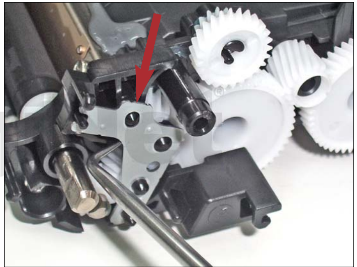
15. Con un gancho, deslizar hacia afuera la placa de retención y tener acceso a los tres engranajes restantes detrás de la placa.
