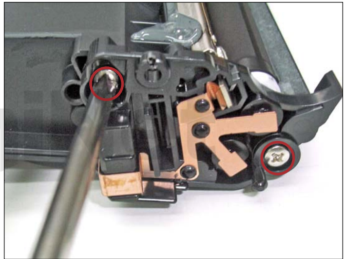
19. En el lado opuesto de la cavidad, sacar los dos tornillos que sujetan el soporte del rodillo revelador, tal como se muestra.
