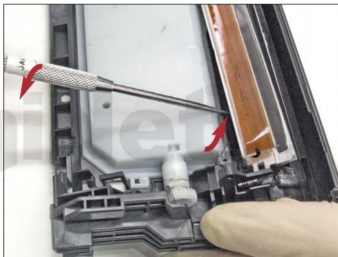
34. Calzar un destornillador fino entre la base de la cuchilla y el cuerpo para hacer palanca. Ayudar con un escalpelo el corte del adhesivo sellador color gris. Posicionar el destornillador sobre la tolva de desperdicios para apoyar y efectuar palanca para despegar la cuchilla de su lugar.
