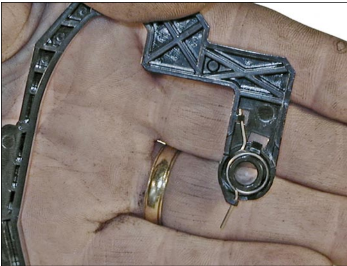
40. Instale el resorte en el brazo de la cubierta del cilindro. Hale la cola superior del resorte hasta que esté en la muesca del eje del brazo.
