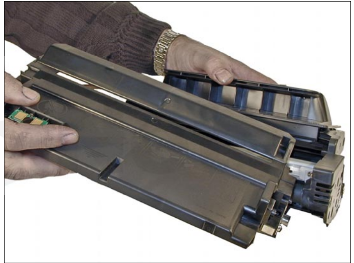
35. Instale la sección de desperdicio en la cubierta lateral fija que está en la cavidad de suministro. Este es un proceso difícil las primeras veces, pero después es mucho más sencillo. La mejor manera de realizarlo es halar con mucho cuidado la cubierta lateral hacia afuera, y deslizar la sección de desperdicio hacia arriba y hacia adentro, hasta que todo este alineado. Las primeras veces, es mucho más fácil decirlo que hacerlo. Pero lo dominará.
