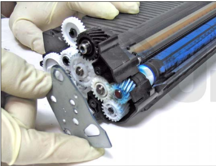
12. Desmontar la placa metalica.
