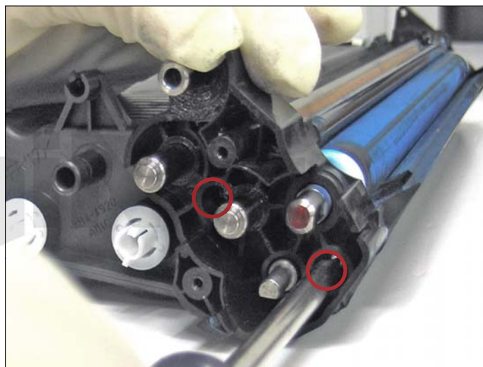
17. Desmontar la otra placa del lado donde estaban los engranajes sacando los dos tornillos que la sujetan.
