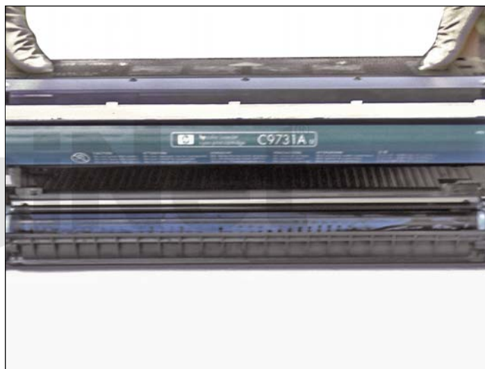
9. Levantar y desmontar la unidad de cilindro del cartucho.
