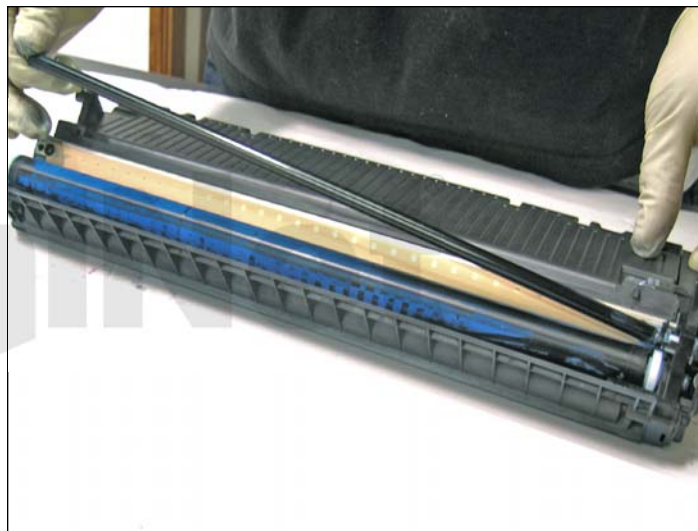
19. Una vez retirada la placa, el rodillo de carga se podrá soltar para su extracción.
