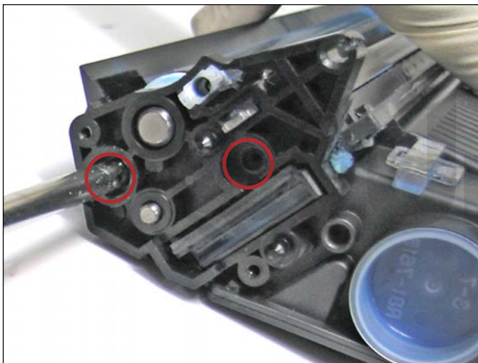
20. Ahora desmontar el soporte del rodillo sacando los dos tornillos como se muestra.
