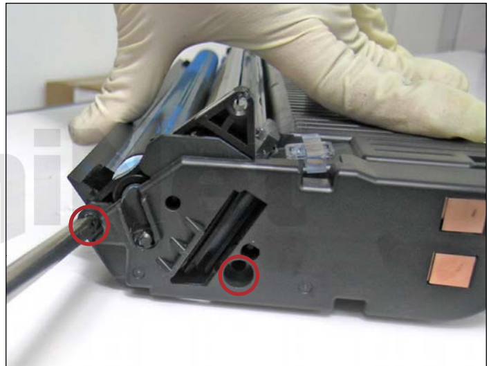
15. Sacar los dos tornillos de lado opuesto como se muestra.
