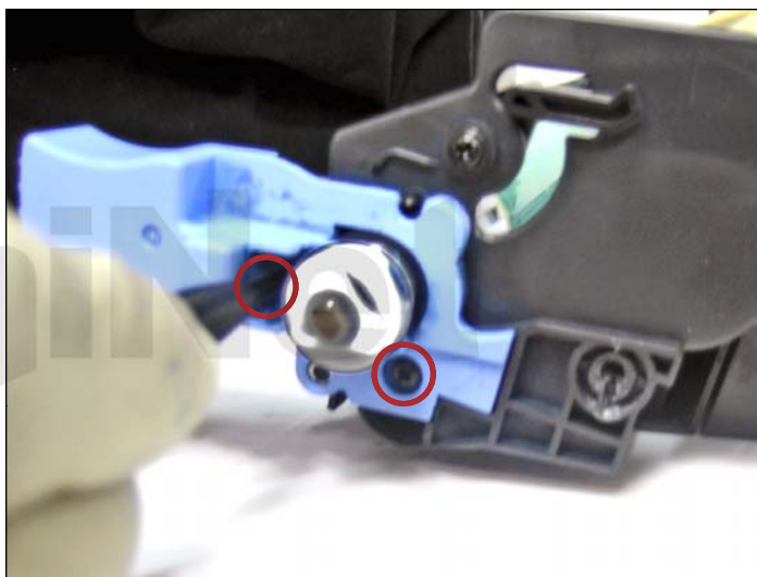
36. Sacar los dos tornillos restantes de la manija de instalación del cartucho como se muestra.
