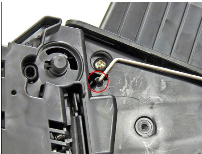
36. Instale las barras metálicas de la cubierta del cilindro en ambos lados del cartucho. Coloque las barras en frente de sus ranuras, y presione en su lugar con ayuda de un desarmador común pequeño.
