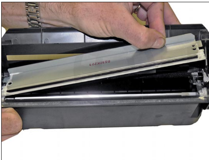
12. Observe que no hay sello adhesivo en la cuchilla limpiadora. Hay solo esponja normal y fieltro debajo de la cuchilla. Remueva la cuchilla limpiadora del cartucho, y limpie el tóner de desperdicio. Tenga cuidado de no dañar el resorte que se sale del soporte negro del PCR. Limpie el PCR con su limpiador estándar.
