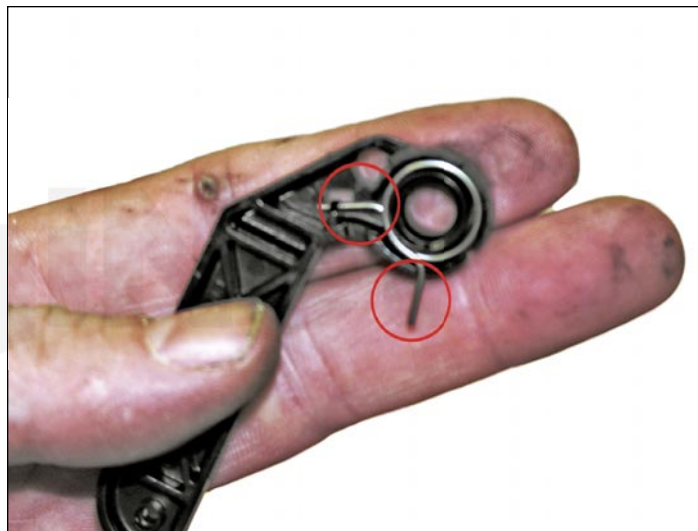
37. Instale el resorte en el brazo de la cubierta del cilindro como se muestra. Jala la cola superior del resorte hasta que sea ajustada en la muesca del eje del brazo.
