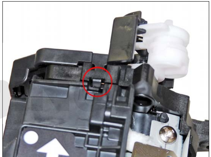
26. En el lado opuesto de la cubierta lateral remueva el único tornillo que hay y presione la lengüeta para liberarla.
