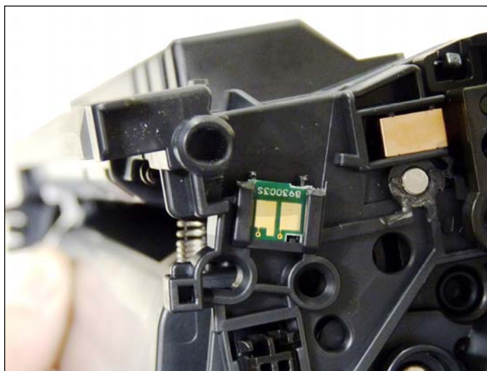
52. Remueva y reemplace el chip. Si el chip nuevo queda suelto en la ranura, cierra los bordes superiores con un poco de pegamento caliente.
