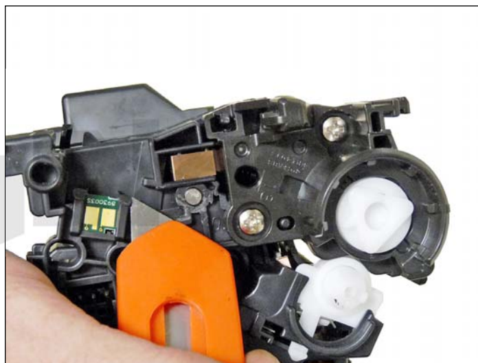
51. Remueva el chip cortando los bordes de plástico en ambos lados el chip.
