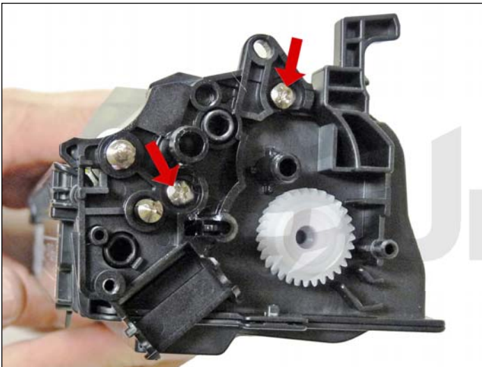
24. Remueva los dos tornillos internos y el engranaje de la cubierta lateral interna.
