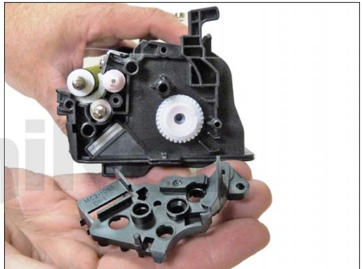
24. Remueva los dos tornillos internos y el engranaje de la cubierta lateral interna.
