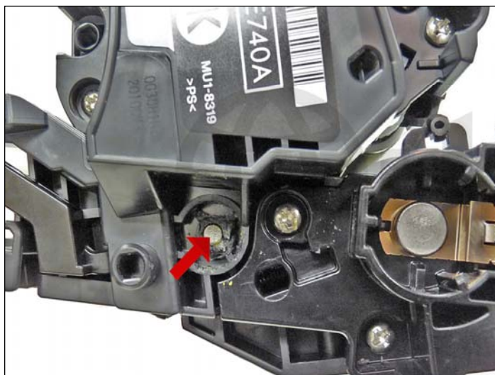
46. Instale los dos pernos, el perno largo hacia el lado de la etiqueta o el engranaje del cartucho.
