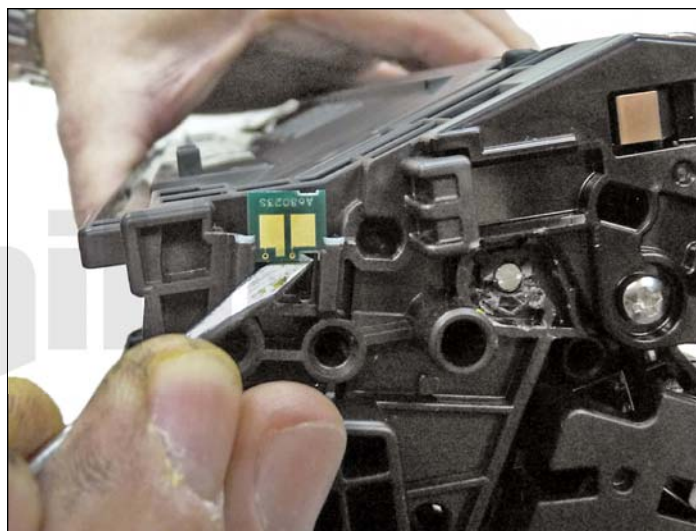
49. Si el chip de reemplazo nuevo queda suelto en la ranura. Cierre los bordes superiores con una pequeña cantidad de pegamento caliente.
