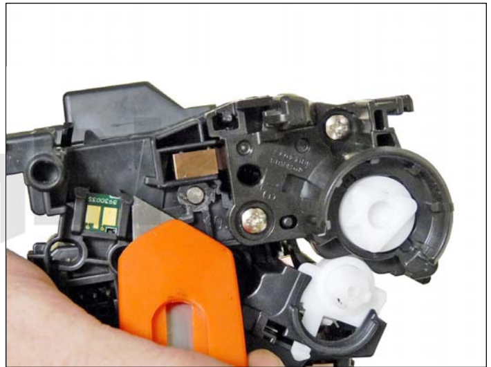
51. Remueva el chip cortando los bordes de plástico en ambos lados el chip.
