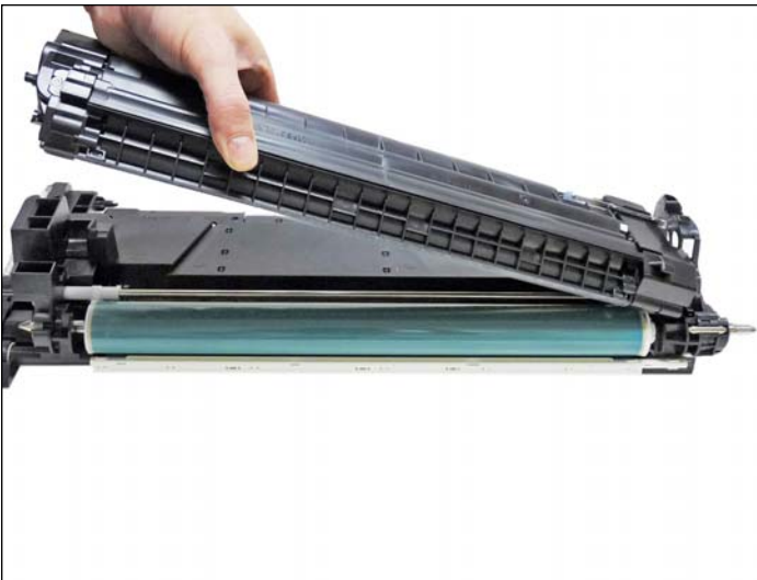
6. Levante la unidad del revelador del cartucho.
