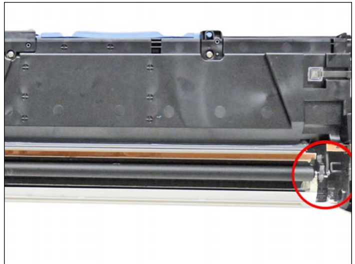
22. Limpie el PCR e instale el ensamble del PCR.
