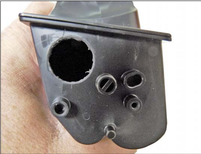
5. Coloque el agujero en la sección superior izquierda como se muestra.
