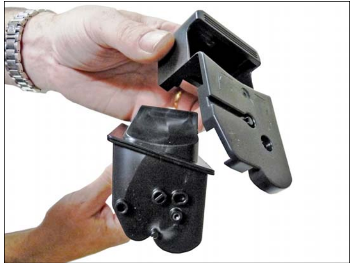
4. Deslice la cubierta hacia arriba y afuera del cartucho.
