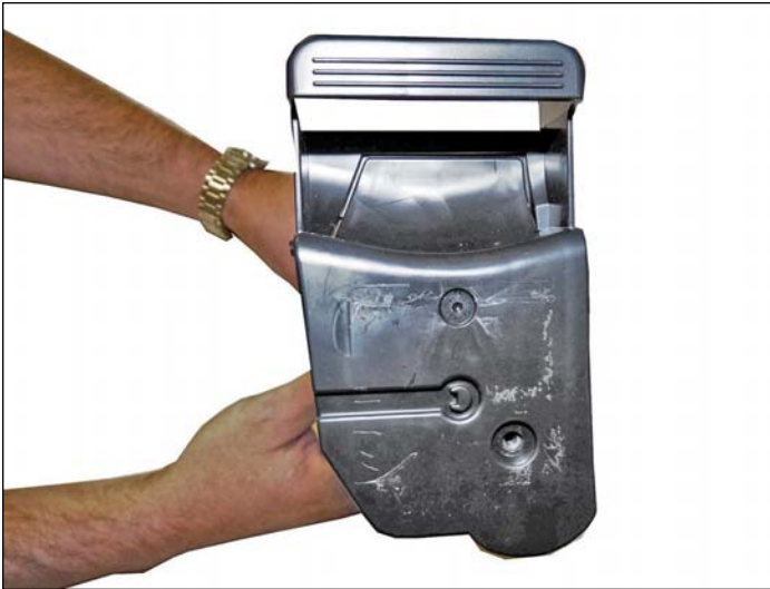
15. Deslice la cubierta lateral de llenado en su lugar. Instale el tornillo y reemplace la etiqueta (como podrá ver la etiqueta se rasga fácilmente).
