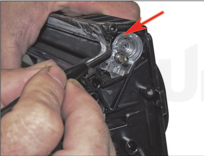
24. Cuidadosamente levante el buje transparente que sostiene al rodillo en su lugar. El buje de plástico puede ser removido levantándolo con un desarmador pequeño alrededor de los bordes. Si elige no realizarlo, puede hacer un agujero pequeño en la cavidad de suministro para limpiarla.
