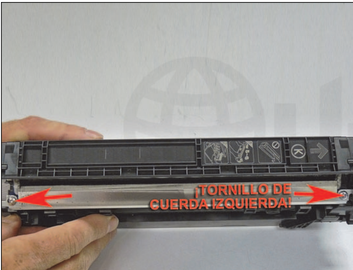
21. Remueva los dos tornillos de la cuchilla dosificadora.
