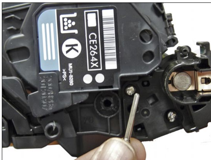
46. Instale los dos pernos. El perno largo hacia la etiqueta o lado del engranaje del cartucho.
