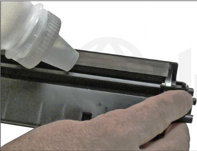
18. Llene la cavidad con tóner para uso en la HP P1102.
