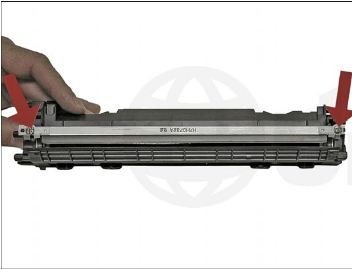
16. Remueva la cuchilla dosificadora y los dos tornillos.
