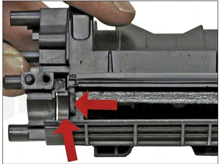
17. Limpie el t  ner de desperdicio de la cavidad. Aseg  rese que los sellos del rodillo magn  tico y los sellos de la cuchilla dosificadora est  n limpios.
