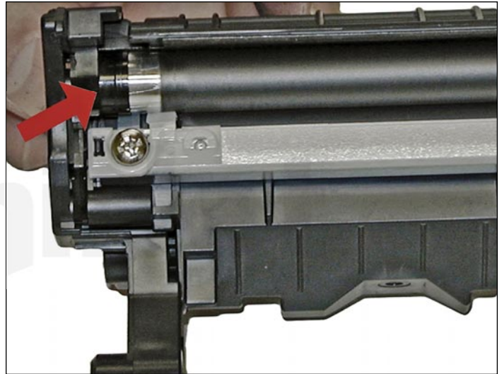
22. Instale el rodillo magnético del lado del buje negro primero. Gire el rodillo hasta que el lado angulado este asegurado en su sitio.
