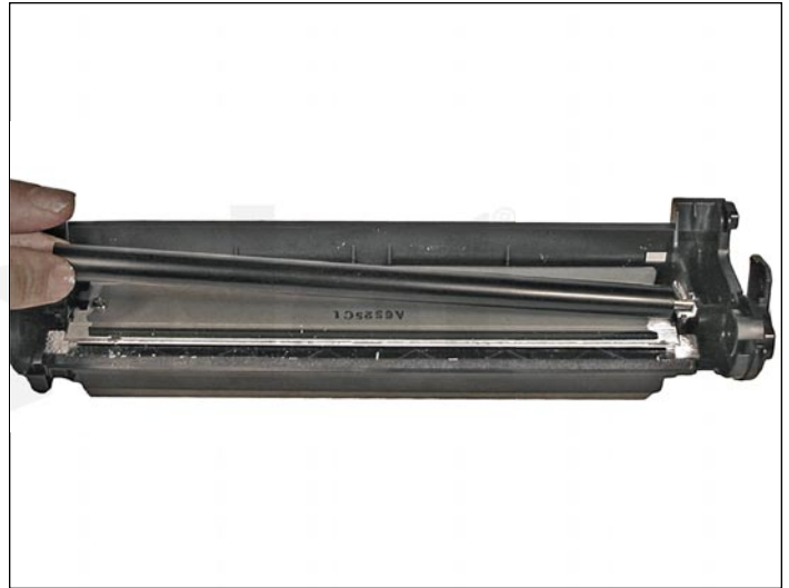
8. Remover el rodillo de carga primaria (PCR), haciendo palanca sobre los clips en cualquier extremo.
