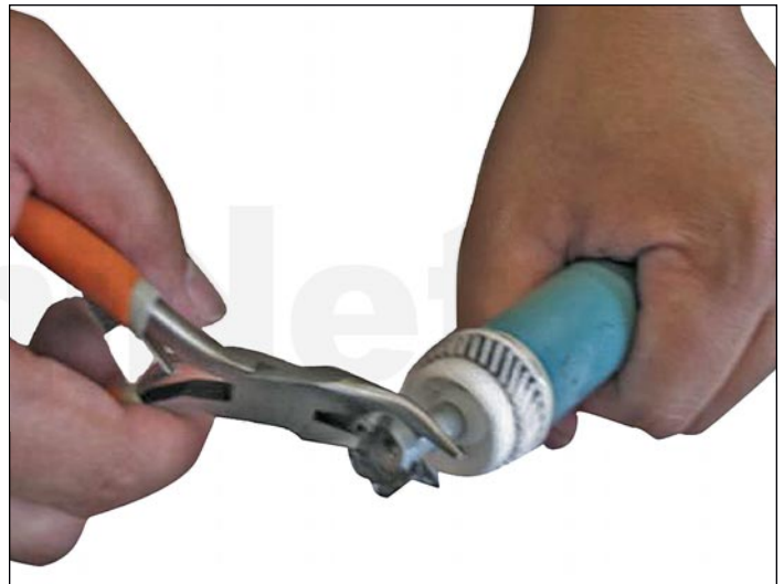
2. Remueva el eje giratorio del engranaje guía halándolo hacia fuera utilizando las pinzas.
