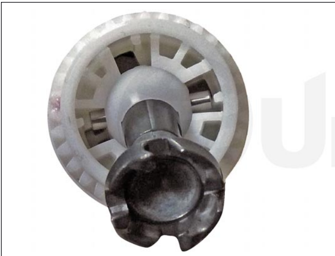
1. Se muestra el eje giratorio en el engranaje guía OPC.
