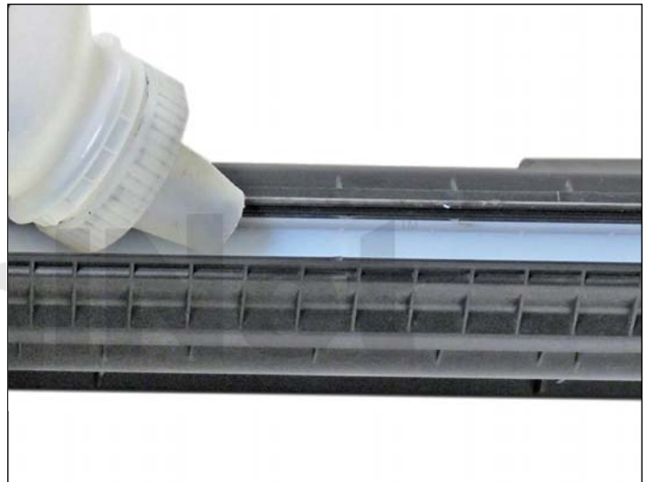
19. Encha o cartucho através do rolo magnético com 110g do toner da P2035 para o cartucho de "A", 290g para o "X".
