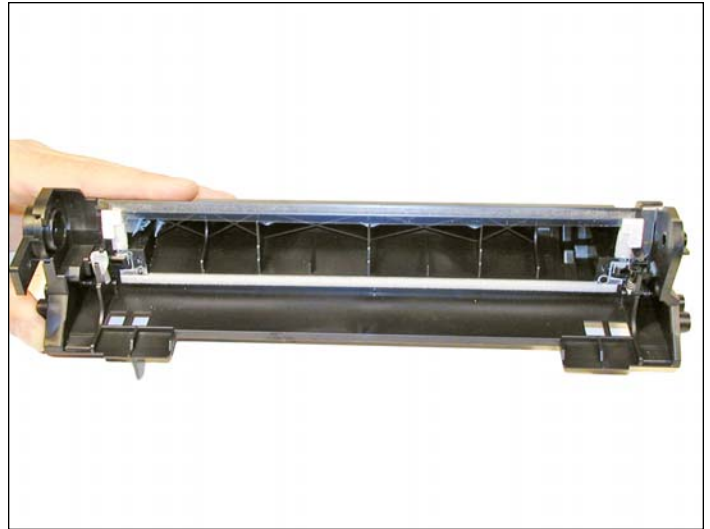
10. Limpie todo el tóner de desperdicio. Asegúrese que los sellos de esponja debajo de la cuchilla limpiadora estén limpios y no estén dañados.
