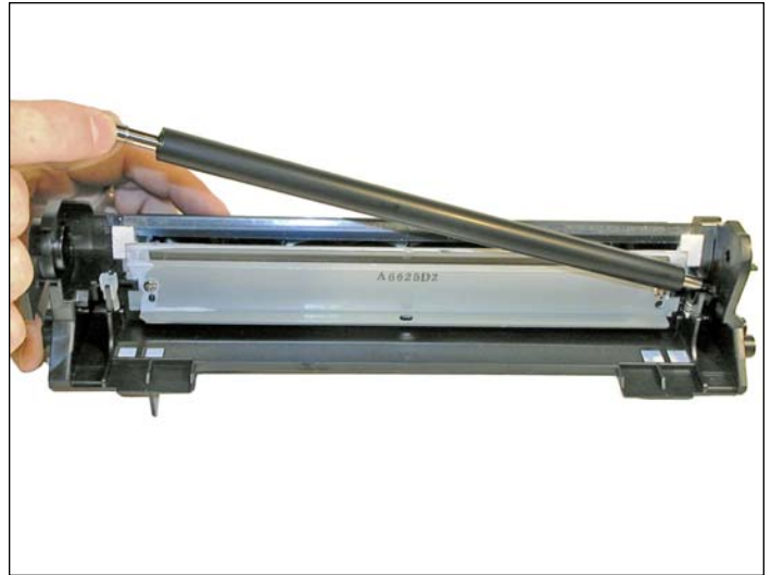
8. Remueva el Rodillo de carga primaria (PCR), halándolo de los clips que están en ambos lados del rodillo. Limpie el PCR con su limpiador preferido y colóquelo a un lado.
