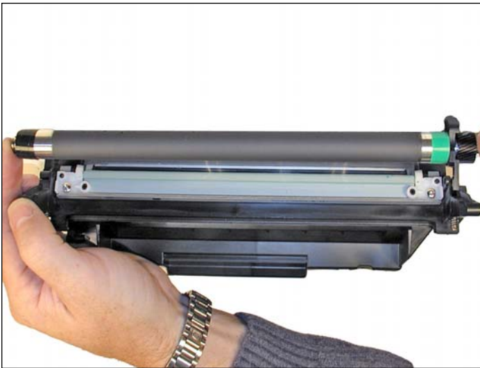
18. Remueva el ensamble del rodillo magnético del cartucho.
