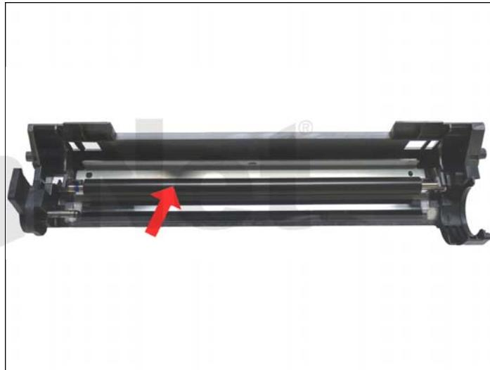
5. Remueva el cilindro fotoconductivo. Retírelo gentilmente tomándolo del perno del eje del cilindro. El perno puede ser removido para hacer que el retirar e instalar el cilindro sea más sencillo, pero el plástico es un poco suave y si no es instalado perfectamente el agujero del eje del cilindro se hará más grande permitiendo que el cilindro este flotando.
