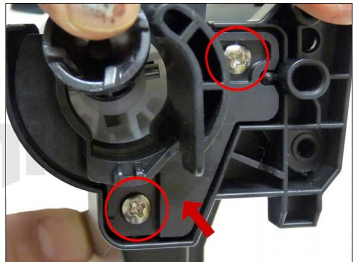
4. En la sección de desperdicio, remueva los dos tornillos y el buje del cilindro.
