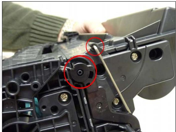
32. Instale el resorte en la cubierta del brazo del cilindro como se muestra.
