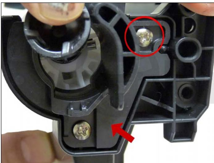
12. Instale los bujes del cilindro y atornille los dos tornillos.
