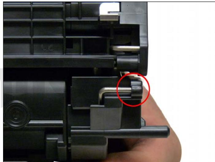
30. Instale la cubierta lateral del lado opuesto y los dos tornillos.
