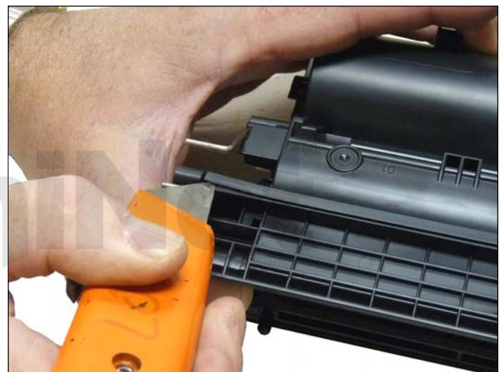
19. No hay agujero de llenado en estos cartuchos así que debe ser llenado a través de la ranura de la cuchilla dosificadora. Llene el cartucho "A" con 295 g de tóner para uso en la HP 3015. Y para el cartucho "X" use 590 g de tóner para uso en la HP 3015.
