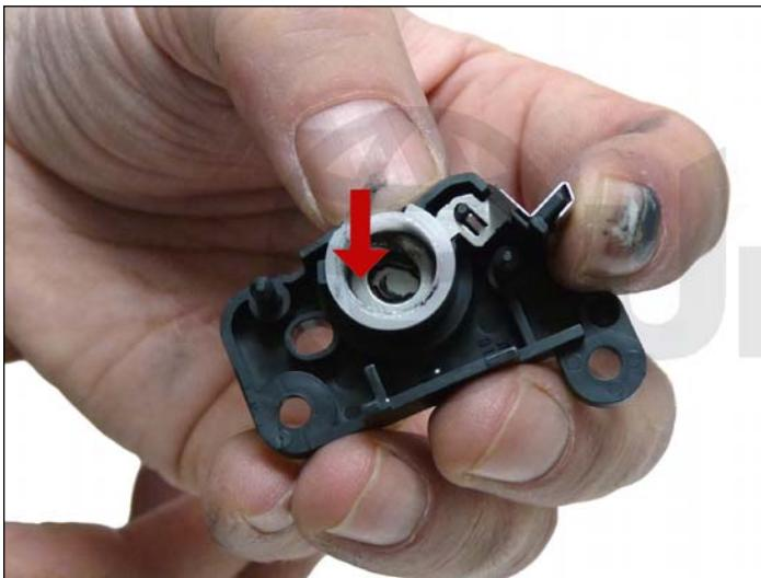
26. Limpie la placa de contacto del rodillo magnético en la cubierta lateral de contacto. Reemplace la grasa conductiva.
