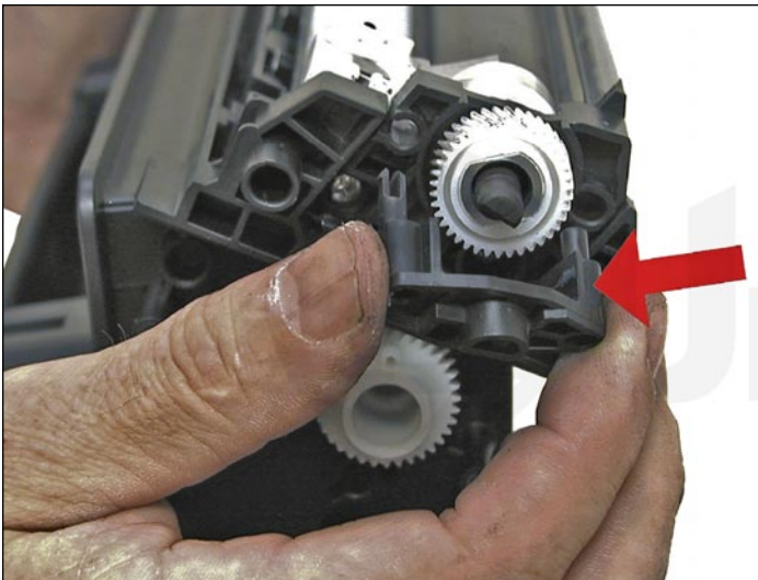
19. En la tolva de tóner, hacer palanca para levantar y sacar la tapa del rodillo magnético.
