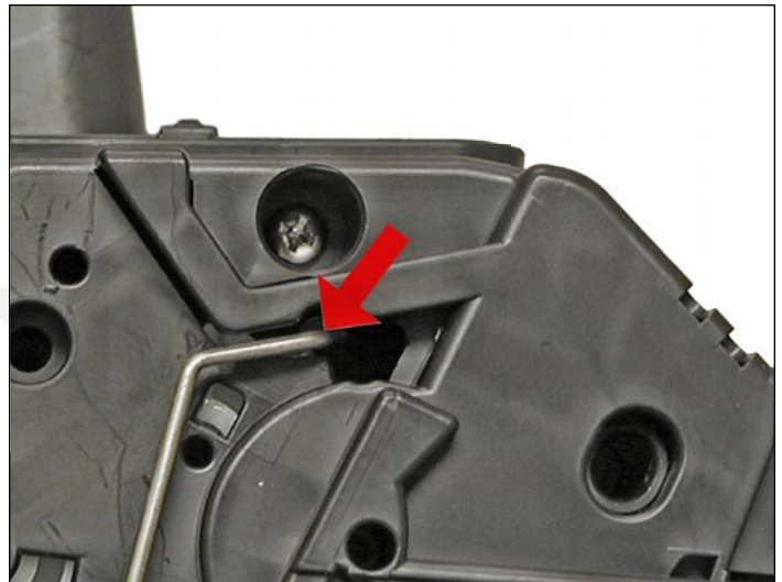
41. Montar la barra metálica de la tapa del OPC en ambos lados del cartucho.
