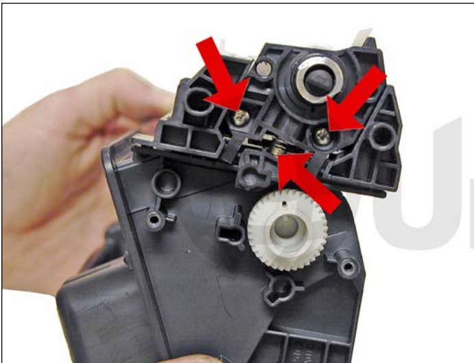
21. Recordar la posición del resorte que está ubicado entre el soporte del rodillo magnético y la tolva. Sacar los dos tornillos del soporte y cuidar de las lengüetas que lo sujetan.
