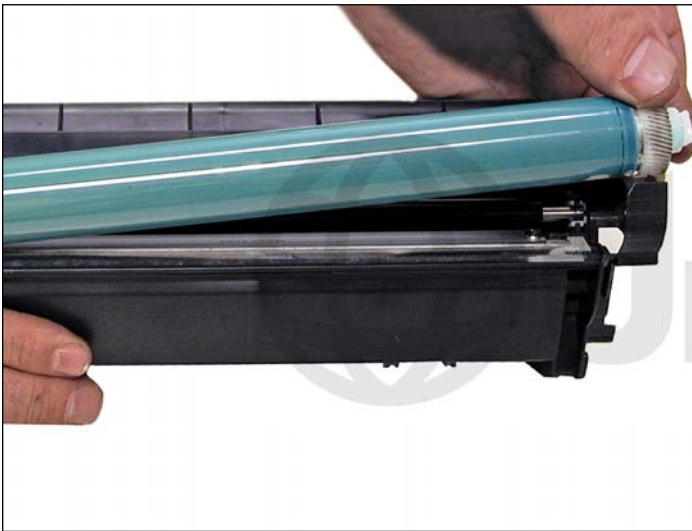
9. Sacar el cilindro OPC izando primero del lado engranaje para luego deslizar hacia fuera del eje opuesto.
