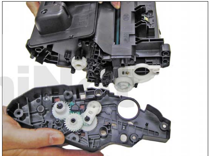
6. Sacar los dos laterales cuidando no se caigan los engranajes del lateral.
