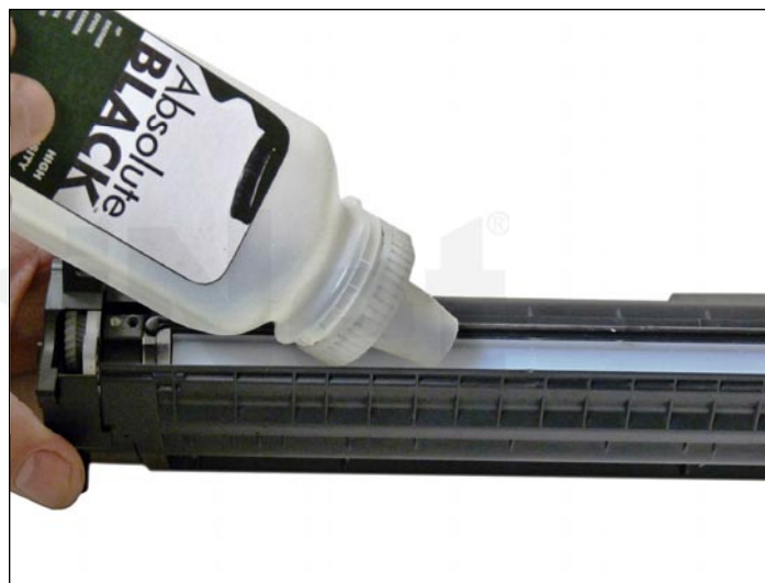
30. Llenar, a través de la abertura del rodillo magnético, con 120 grs. de toner P2035 para cartucho "A", 290g para el "X". No hay tapón de llenado en estos cartuchos.
