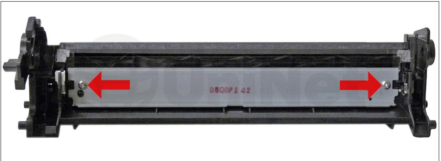
8. Remover los dos tornillos y la cuchilla limpiadora.
