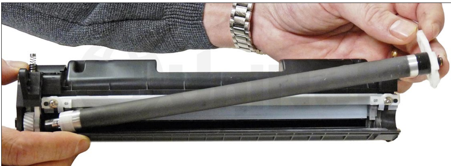
26. Remover el montaje del rodillo magnético.
