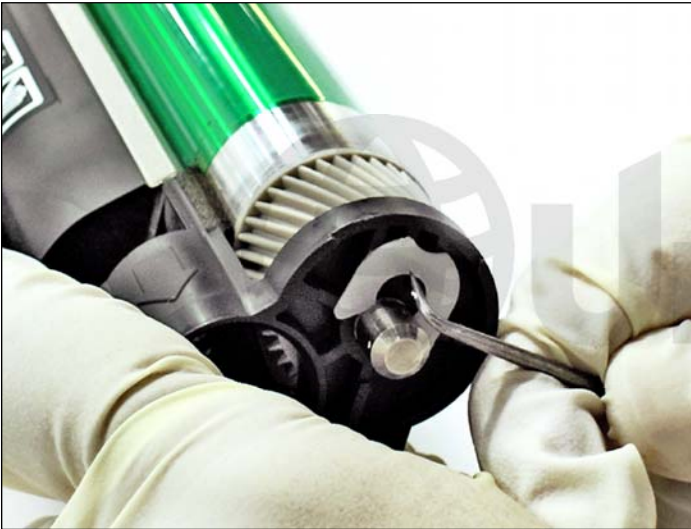
1. Extraer el clip en "U" con ayuda de un desarmador pequeño o gancho como se muestra.
