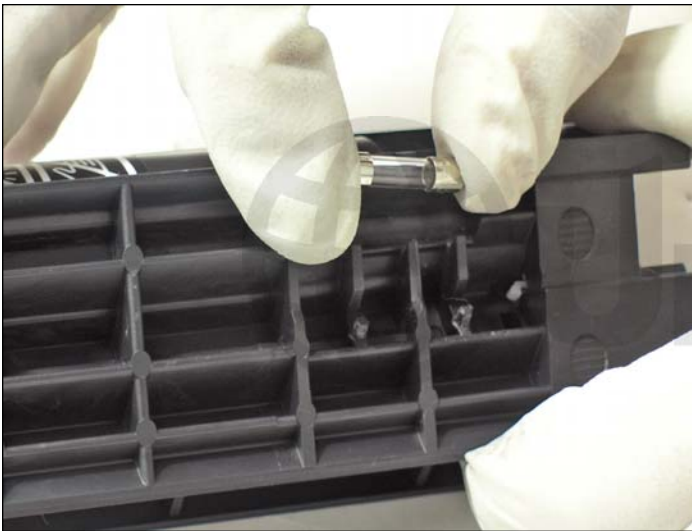
12. Retirar el fusible quemado y reemplazar con uno nuevo.
