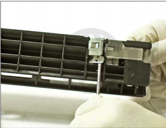
11. Levantar las placas con un desarmador plano pequeño.
