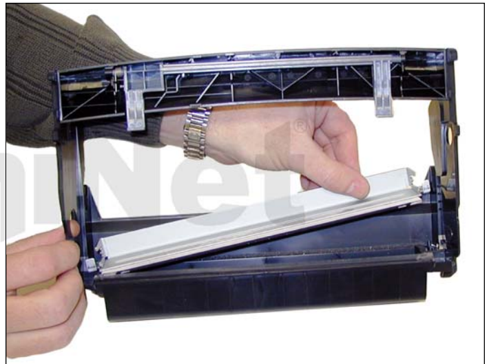
7. Remueva la cuchilla limpiadora, y limpie el t nner de desperdicio.
