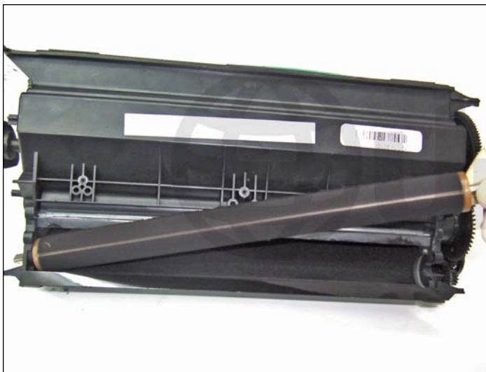
29. Finalmente, remueva el rodillo revelador como se muestra.
