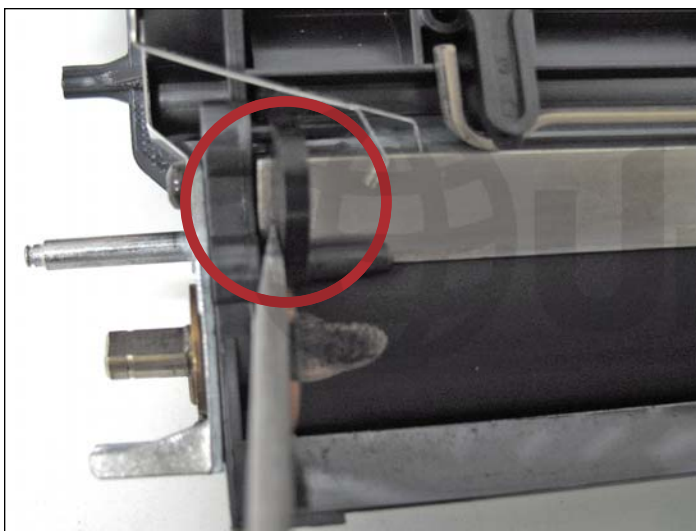
21. Primero, deslice hacia afuera la lengüeta retenedora (mostrada) que sostiene la barra dosificadora en su lugar.
