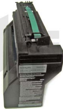
VISTA LATERAL DE LA CAVIDAD DE DESPERDICIO
