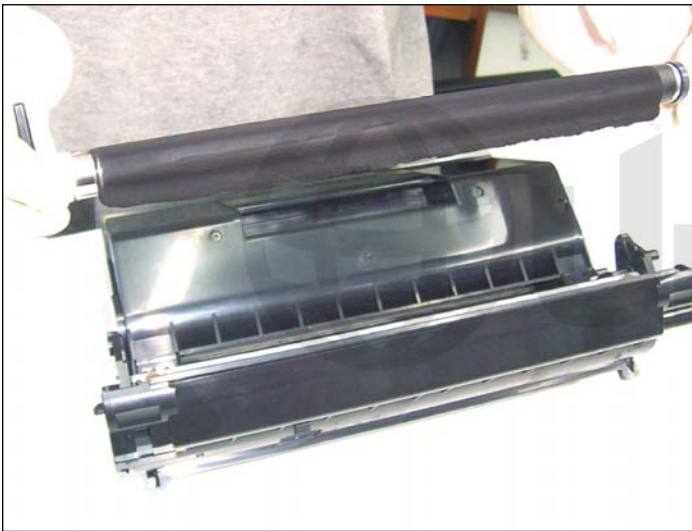
41. Continuar con el otro extremo y retirar totalmente el rodillo.
