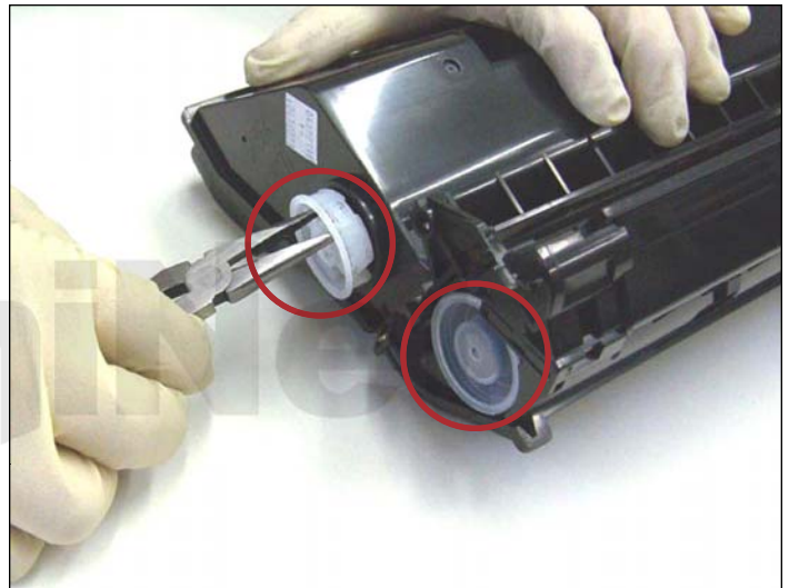
44. Con un par de pinzas de puntas agudas sacar las dos tapas de recarga ubicadas del lado de los engranajes. Vaciar el tóner remanente, limpiar con aire comprimido o aspiradora antes de separar el depósito.
