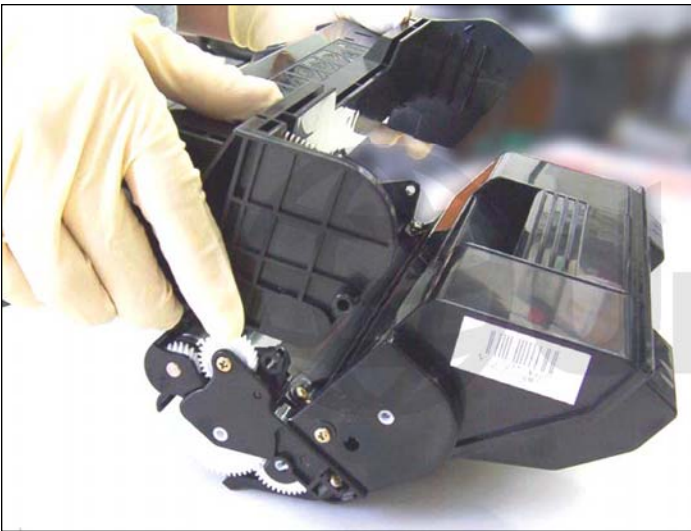
14. Separar uniformemente la unidad de cilindro del cartucho.
