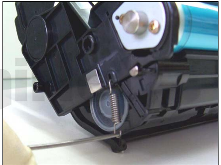
13. Sacar el resorte del lado sin engranajes con un gancho.
