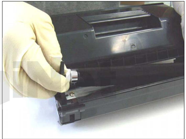
40. Una vez levantada la palanca, levantar el rodillo de ese lado.
