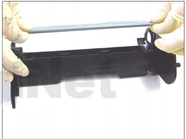
29. Una vez limpio se procede al montaje de la cuchilla de limpieza.
