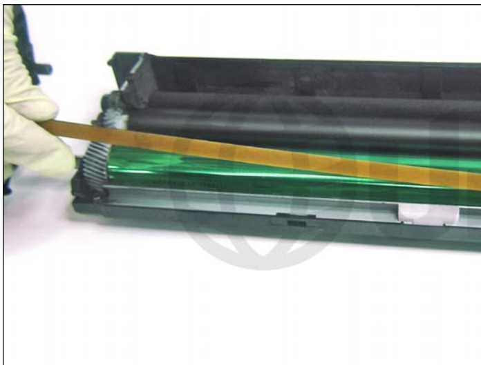
12. Sacar la lámpara de borrado del cilindro como se indica.
