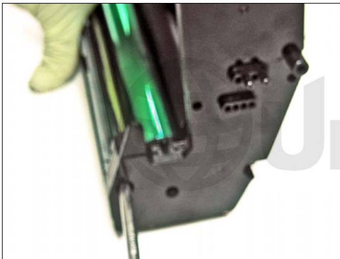
14. Destornillar los dos tornillos de la tapa lateral opuesta lado engranajes.
