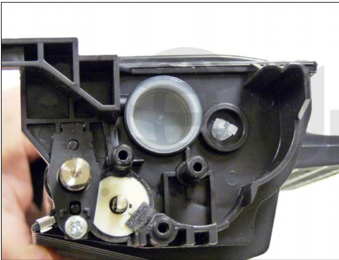
14. Remueva el engranaje del área del tapón de llenado presionando la lengüeta.
