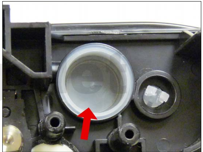
15. Remueva el tapón de llenado y limpie el tóner de desperdicio de la cavidad.
