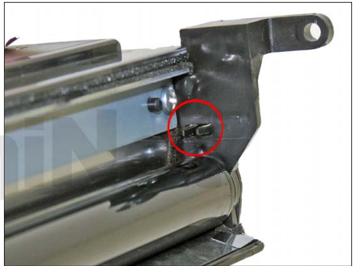
16. Remueva el tornillo y la base del lado del engranaje del rodillo revelador.
