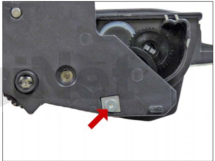
35. Instale las placas metálicas y los tornillos.
