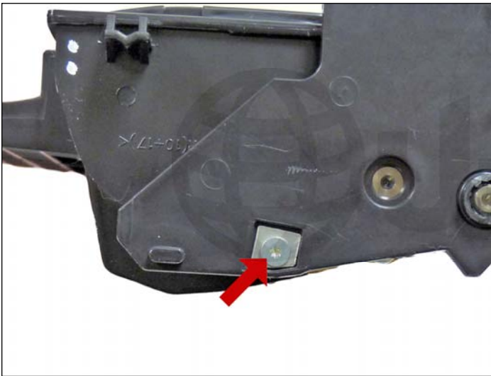
35. Instale las placas metálicas y los tornillos.
