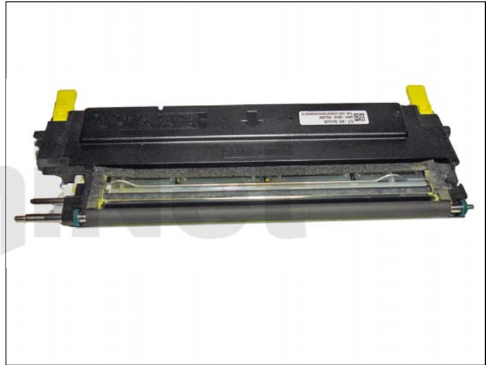
13. Instale el rodillo revelador con su respectivo buje de separación verde en su posición e inserte el eje a través del soporte, después bloquee el otro lado en su sitio.
