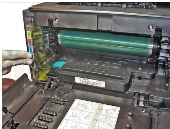
22. Observe la cavidad de desperdicio instalada (lado izquierdo). La cavidad de desperdicio es el soporte del lado izquierdo para los cartuchos de t ner.
