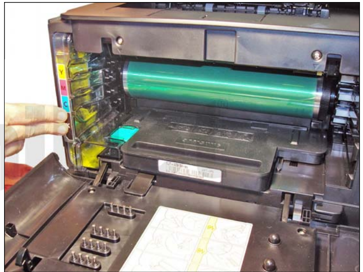
22. Observe la cavidad de desperdicio instalada (lado izquierdo). La cavidad de desperdicio es el soporte del lado izquierdo para los cartuchos de tóner.
