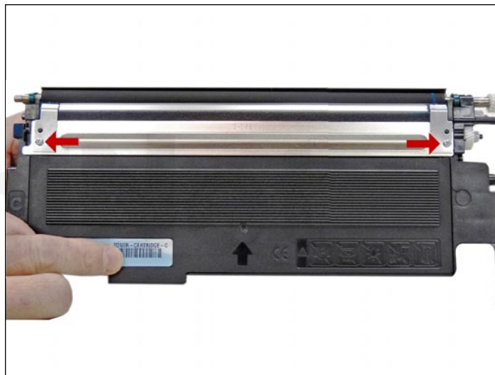
19. Limpie cuidadosamente la cubierta/cuchilla dosificadora e instálela. Coloque las placas de presión individuales de la cuchilla dosificadora correctamente en su lado y asegure con los dos tornillos.
