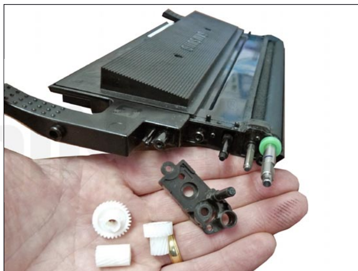
7. Sacar los tres engranajes siguientes, los dos tornillos y la placa interior de engranajes.
