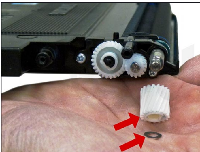
6. Sacar la arandela y el engranaje de impulsión del rodillo revelador del eje del rodillo.
