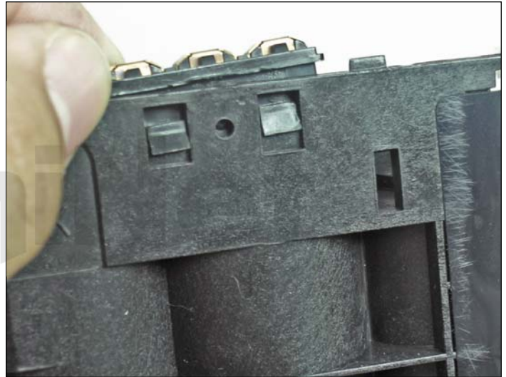
15. Finalmente instalar el conjunto de contactos en el cartucho.
