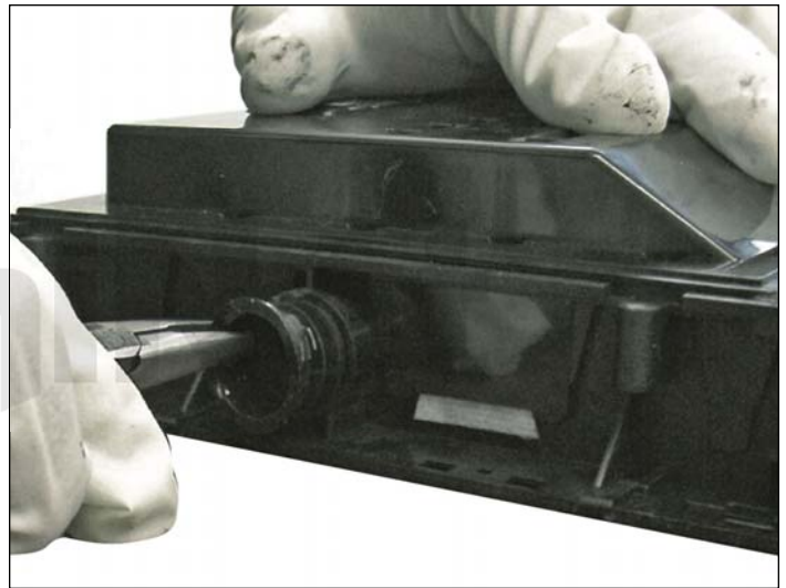
8. Extraer el tapón y empezar la limpieza del deposito, usar el aspirador en áreas accesibles y aire comprimido en lugares de difícil acceso o partes mas sensibles.
