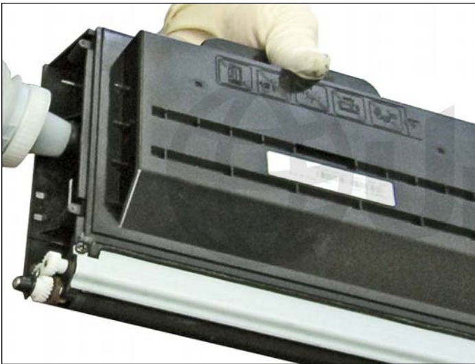
9. Luego de una limpieza completa y reinstalación de los componentes limpios del cartucho proceder a efectuar la recarga del deposito.
