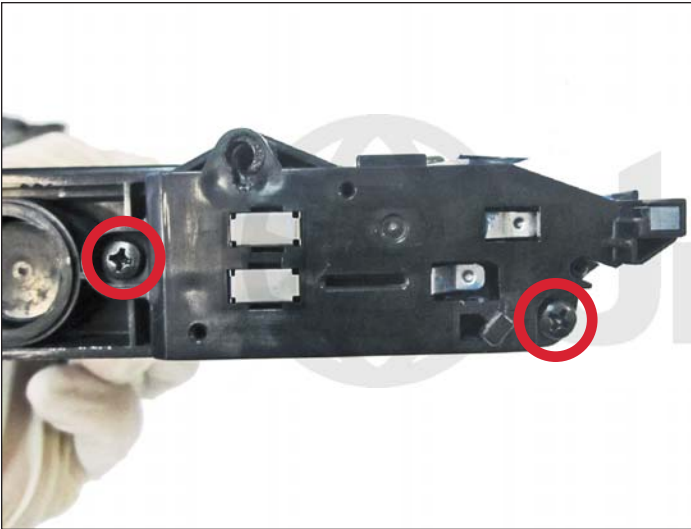
23. Remueva los dos tornillos de la placa de contacto final.
