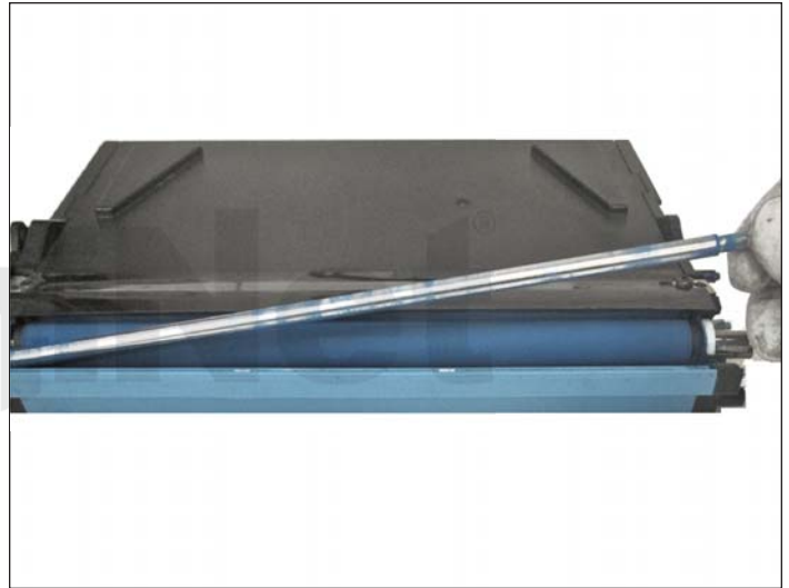
22. Remueva el rodillo de carga de tóner.
