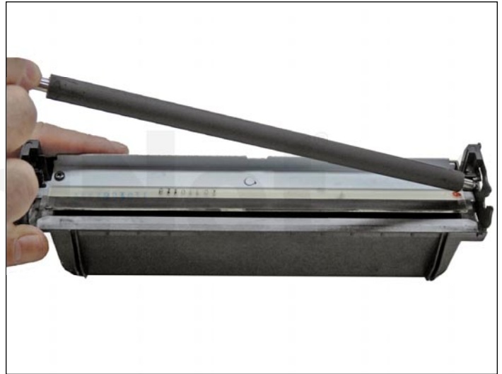
10. Remueva el PCR del ensamble. Limpie el PCR con su limpiador regular de PCR.
