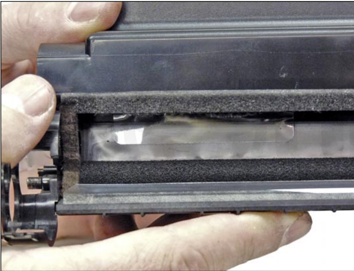
29. Instale el sello cuando esté disponible a través de la abertura del rodillo revelador.
