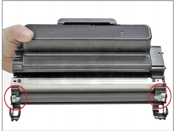
32. Limpie el rodillo revelador con un limpiador especial para rodillos reveladores y colóquelo en la cavidad. Coloque el lado largo del eje hacia el lado del engranaje primero. Se ajustará en su sitio si es colocado de manera correcta.
