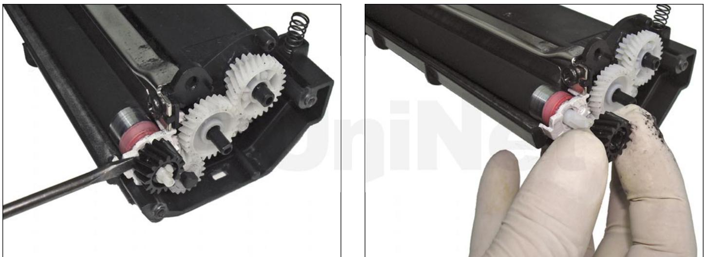
14. Retirar el engranaje negro del rodillo revelador haciendo palanca con el desarmador pequeño.
