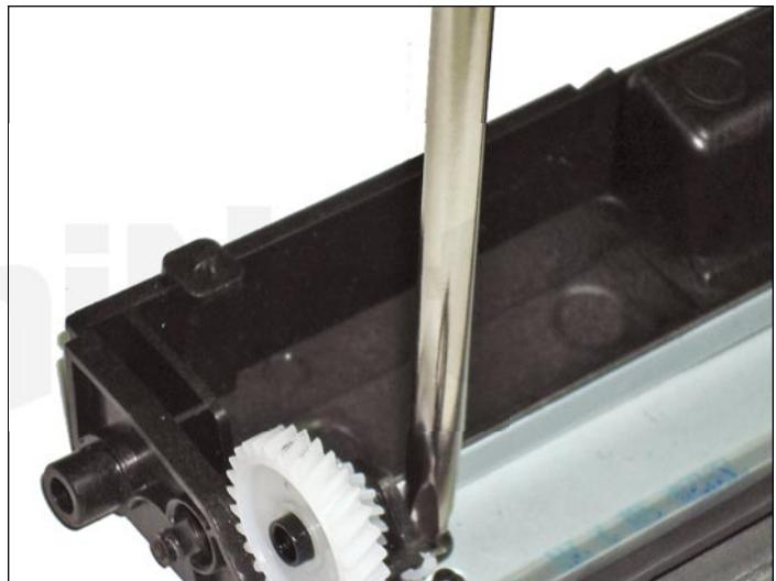
11. Instale la cuchilla de limpieza nueva o la usada bien limpia y previamente lubricadas con polvo de asentamiento.
