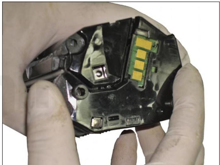
26. Tome el lateral lado contactos y desplace el chip original de su lugar, substituya con un chip nuevo. Proceda a lubricar los puntos de contacto en el interior del lateral e instale en el cartucho haciendo que el contacto externo pase a través del agujero cuadrado de la pieza.
