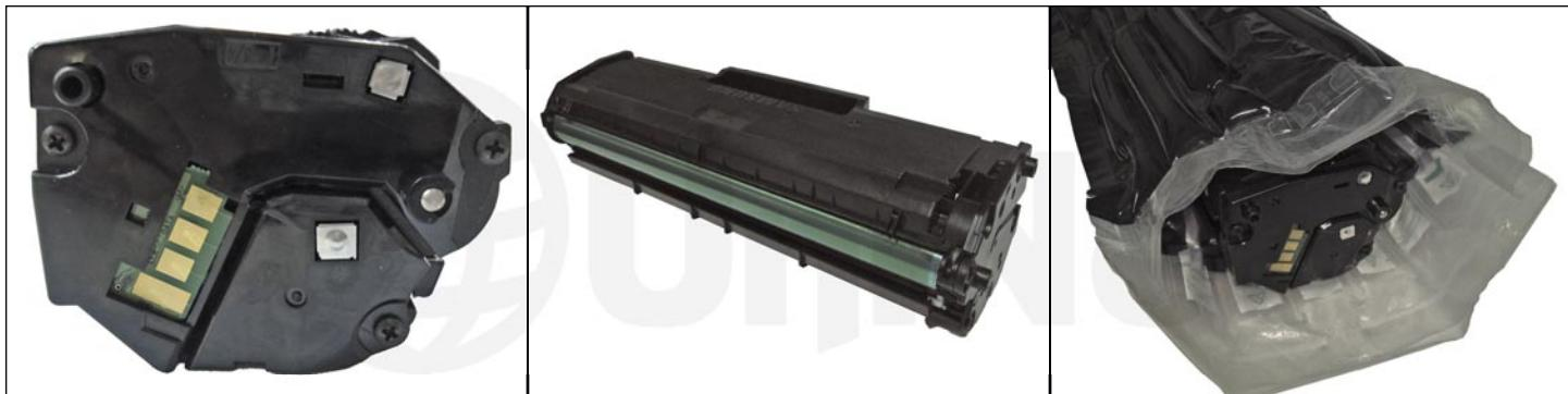
27. Atornille el lateral de lado contactos y proceda con la prueba final del cartucho.
