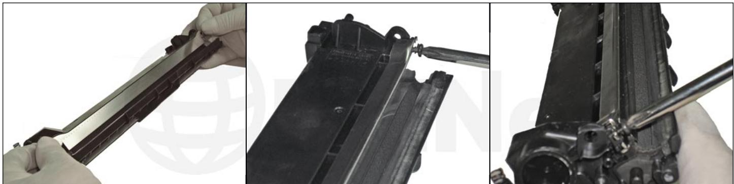
20. Instale ahora la cuchilla dosificadora y fíjela con sus dos tornillos.
