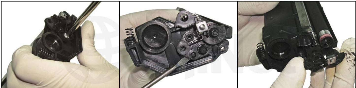
15. En el lado opuesto de la sección destornille y desmonte la placa de contacto del rodillo. Debe notarse la inexistencia de un resorte de contacto y debe deducirse que el inserto en donde calza el rodillo está construido de plástico conductor de electricidad. La cantidad de grasa conductiva que este inserto posee da la pauta de la necesidad de lubricación y conducción para su correcto funcionamiento.
