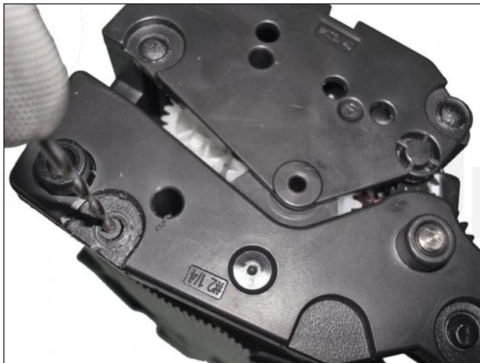
2. Marque el centro de cada perno remanente y agujere con mecha de 2 mm hasta una profundidad no mayor a 5 mm.
