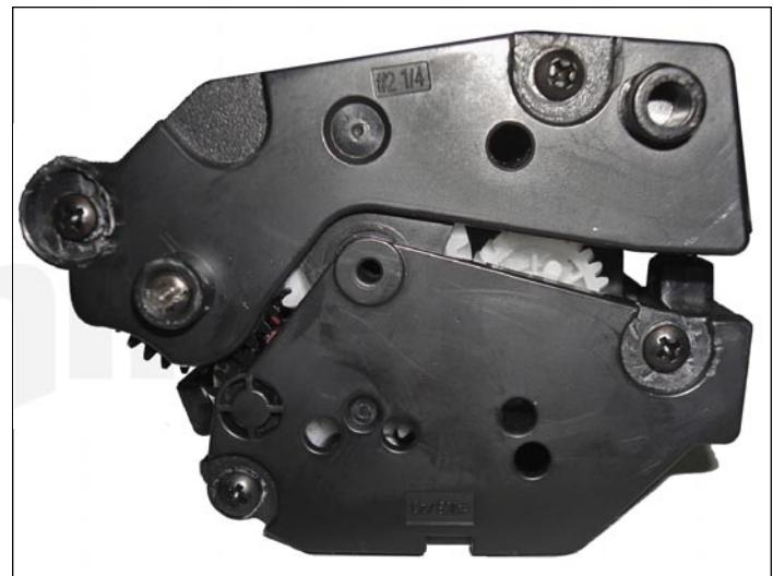
25. Mantenga las dos secciones juntas, presente el lateral menor lado engranajes y empújelo para que la media caña del eje del OPC entre en el agujero correspondiente. Atornille el lateral. Inserte luego el lateral mayor en coincidencia con el anterior y atornille.
