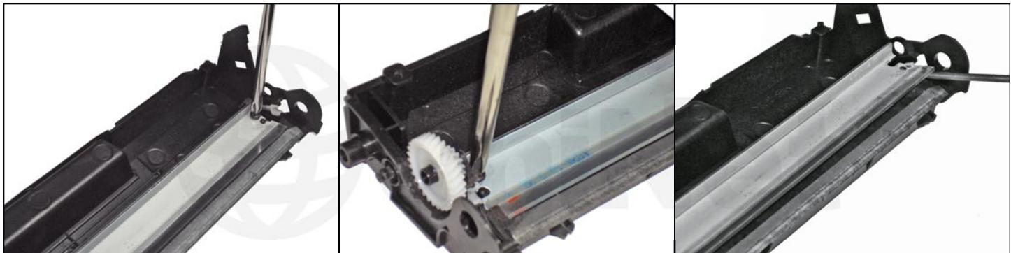
9. Retire los dos tornillos que sujetan la cuchilla de limpieza y levante la misma de su lugar.
