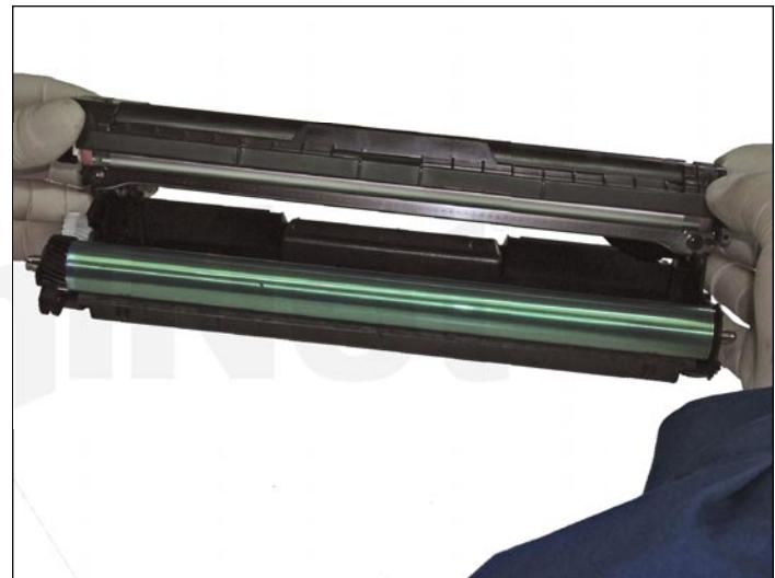
24. Tome la sección de imagen y colóquela encima de la sección de revelación para el armado final posicionando los dos resortes de compresión.
