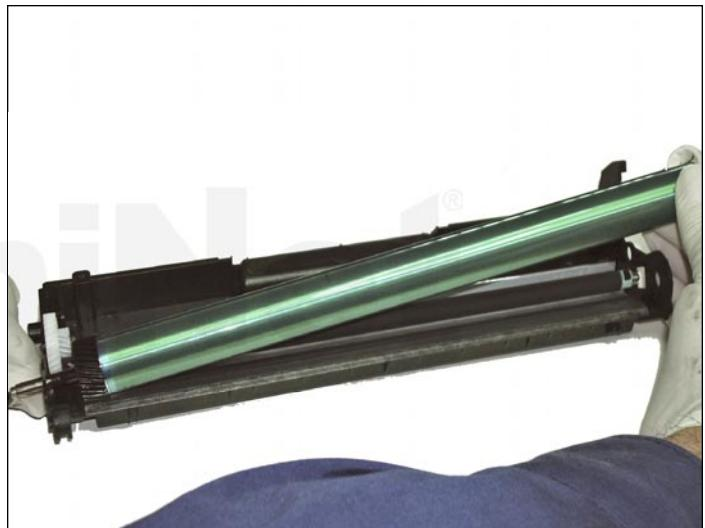
7. Deslice el eje del cilindro OPC lo suficiente para poder levantar el extremo y sacarlo de su posición.
