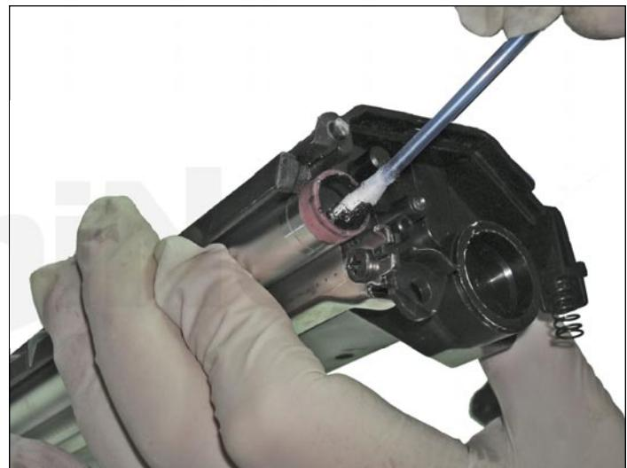
21. Instale ahora el rodillo revelador directamente si es que no ha retirado el soporte haciendo que el extremo calce perfectamente en el buje separador colorado. Lubrique el otro extremo del rodillo con grasa conductiva
