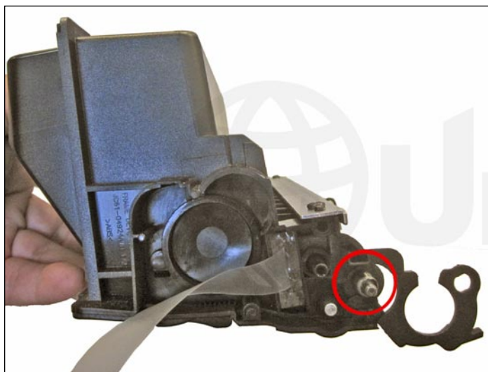
28. Limpe e substitua a graxa condutiva que esta no lado menor do eixo do rolo. Coloque o toner específico para uso em Samsung ML-3750.
