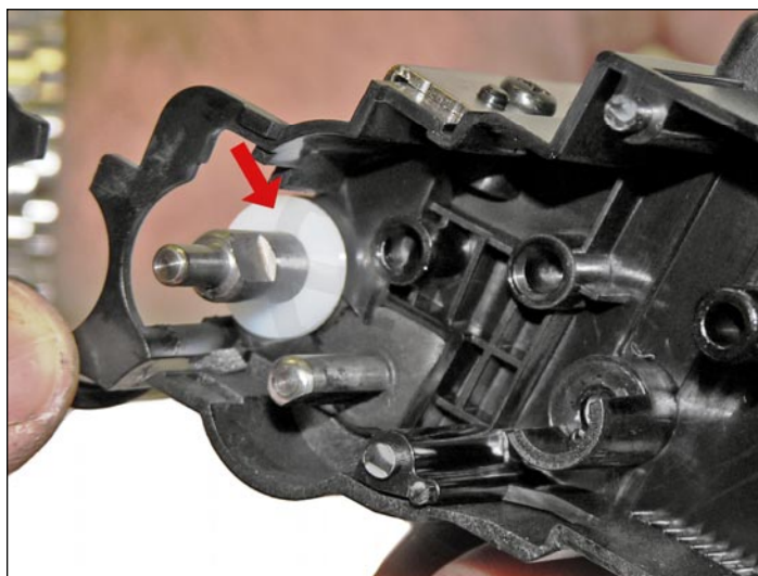
19. Remova as buchas do rolo revelador de ambos os lados.
