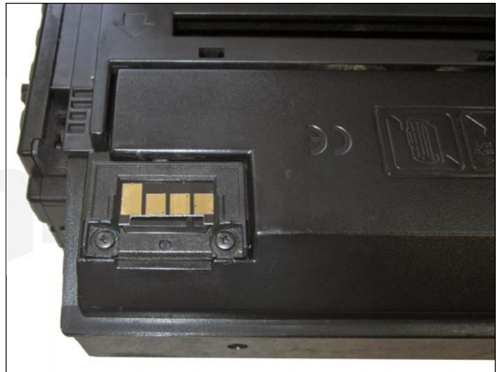
42. Instale el soporte del chip, e instale los dos tornillos en el soporte del chip.
