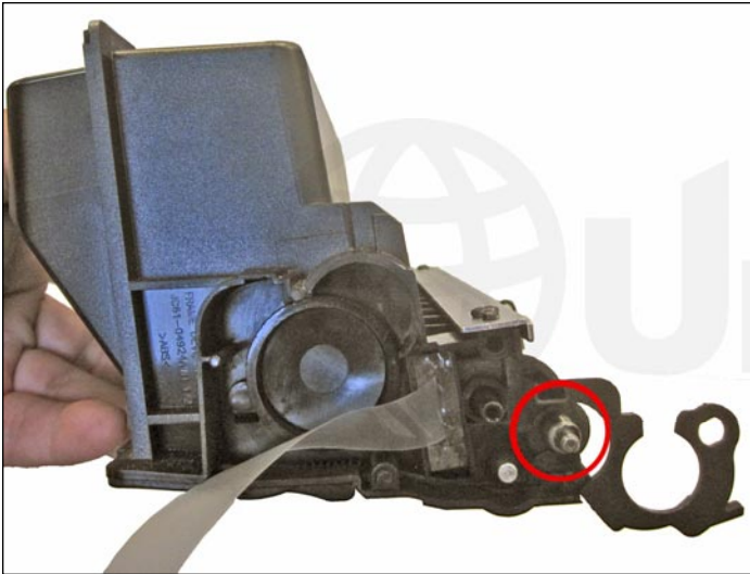
28. Limpie y reemplace la grasa conductiva en el lado corto del eje del rodillo. Llene la cavidad con tóner para uso en el cartucho Samsung ML-3750. Reemplace el tapón de llenado y revise que no presente escurrimientos.
