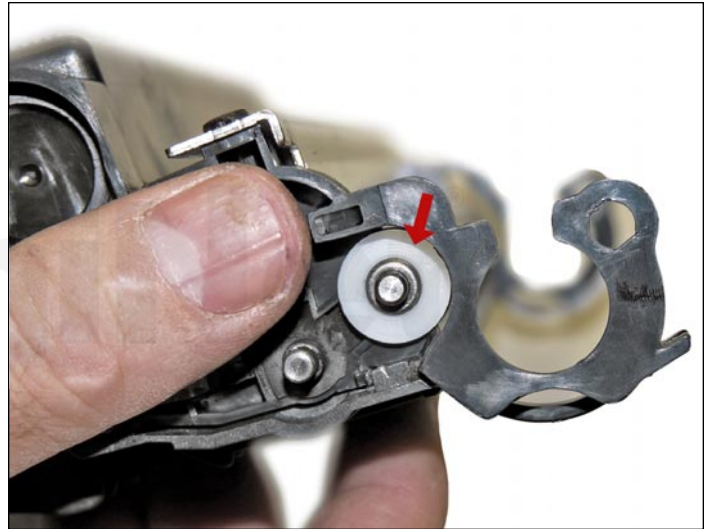
19. Remueva los bujes del rodillo revelador de ambos lados.
