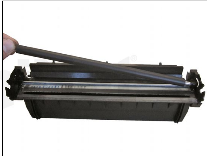
10. Remueva el PCR del ensamble. Limpie el PCR con su limpiador normal de PCR.
