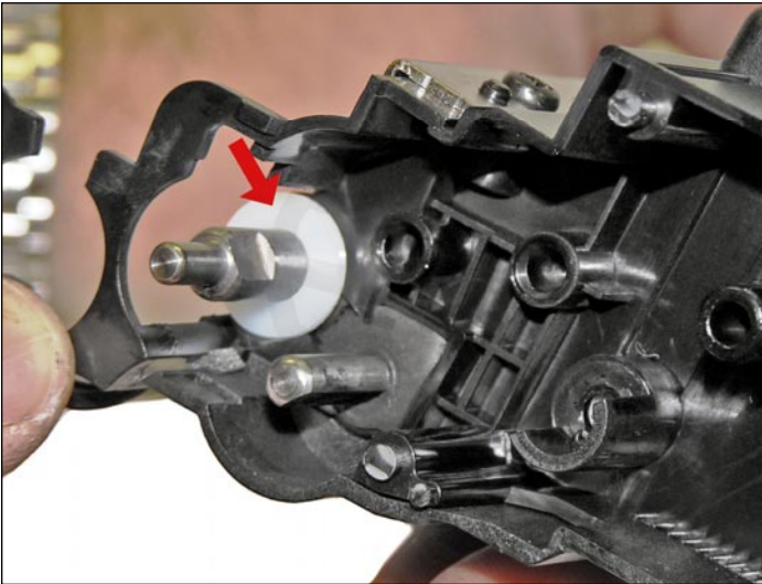
19. Remueva los bujes del rodillo revelador de ambos lados.
