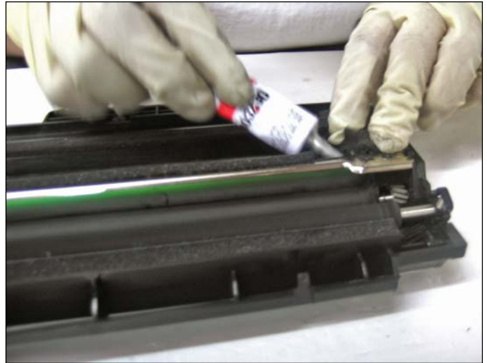
22. Luego de haber instalado nuevamente los componentes, utilizar un sellador de caucho sintético o siliconas para pegar el sello de espuma de goma de nuevo en su lugar original. Este sellado es importante para evitar pérdidas de tóner.
