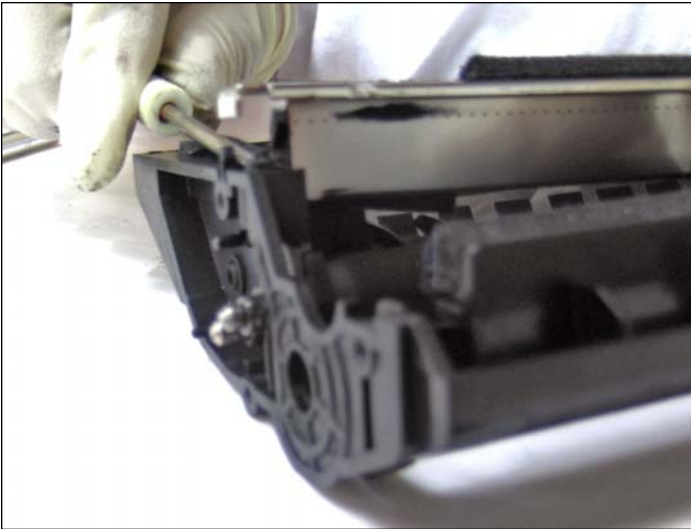
13. Una vez separado el sello se puede sacar la cuchilla dosificadora.
