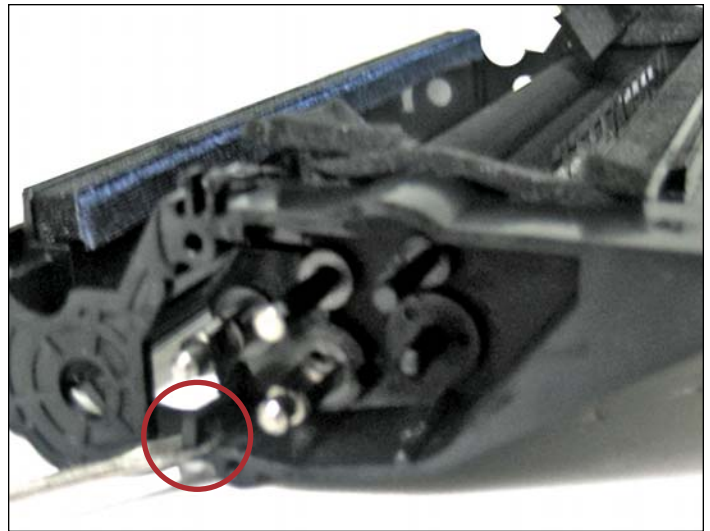
18. Para retirar la placa de soporte del rodillo primero destrabar el clip debajo del eje del rodillo de revelación.
