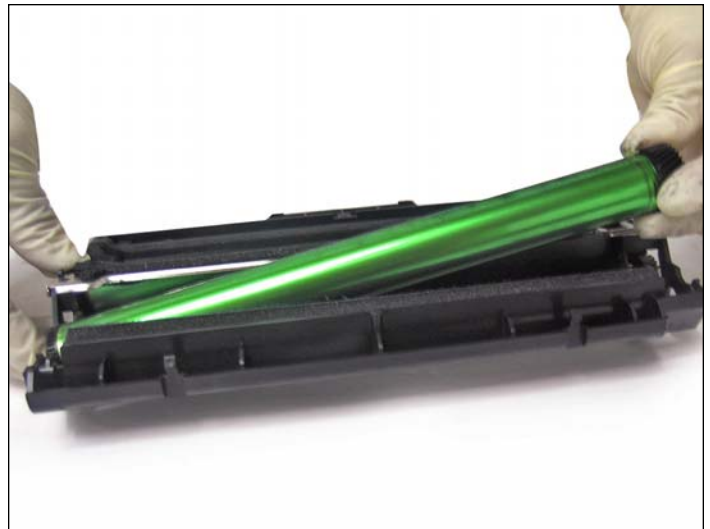
10. Sacar el cilindro cuidando de no golpear o arañar el mismo contra la cuchilla de dosificación.
