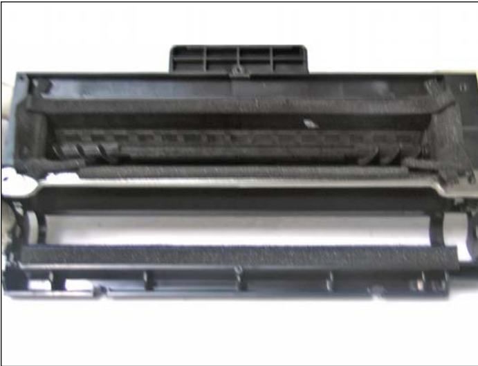
11. Vista frontal del cartucho sin su PCR y cilindro OPC.
