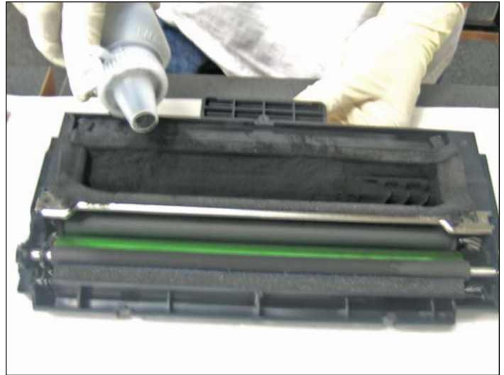
24. Recargar con tóner antes de atornillar la tapa superior.
