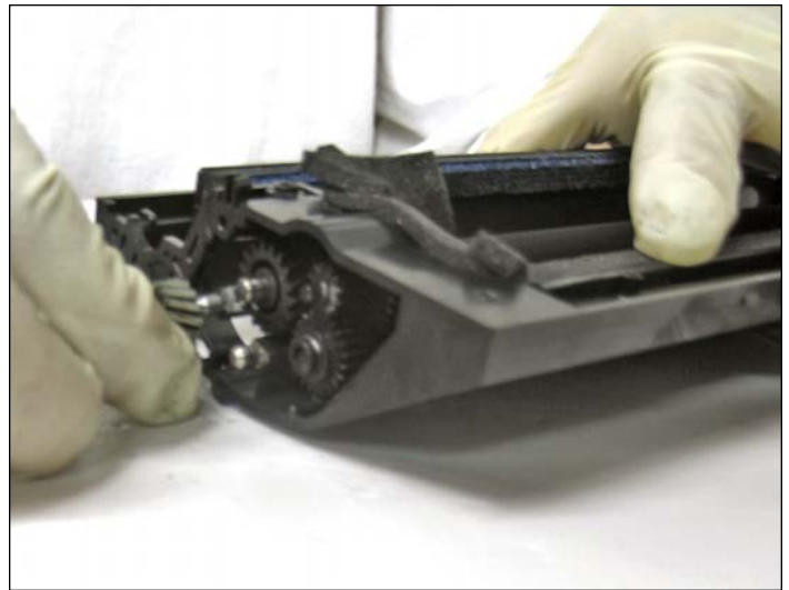
16. Sacar los engranajes como se muestra.
