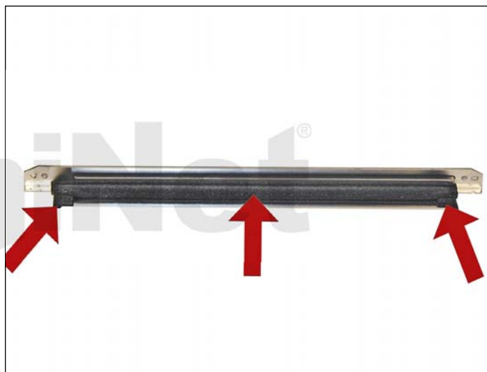
16. Limpie la cuchilla dosificadora y los sellos de esponja. Es muy pronto para recomendar un químico para usar en la cuchilla, pero el alcohol isopropílico al 99% funciona bien.
