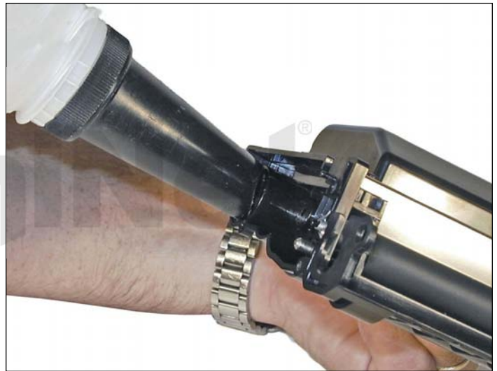
21. Llene la cavidad con la cantidad de tóner para uso en la Samsung SCX-5635 adecuada. Revise que no existan escurrimientos.
