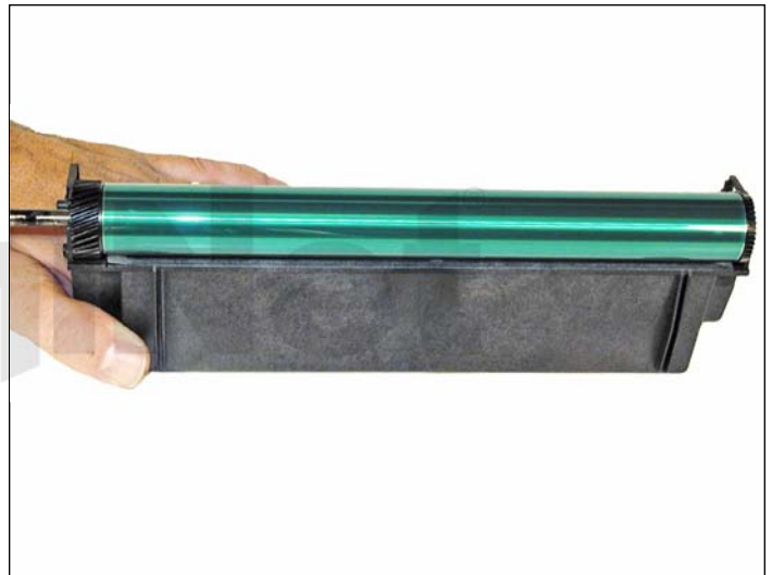
23. Deslice el eje del cilindro hacia fuera por el lado opuesto al anillo-E (lado del engranaje grande).
