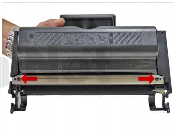
14. Remueva los dos tornillos en la cuchilla dosificadora.
