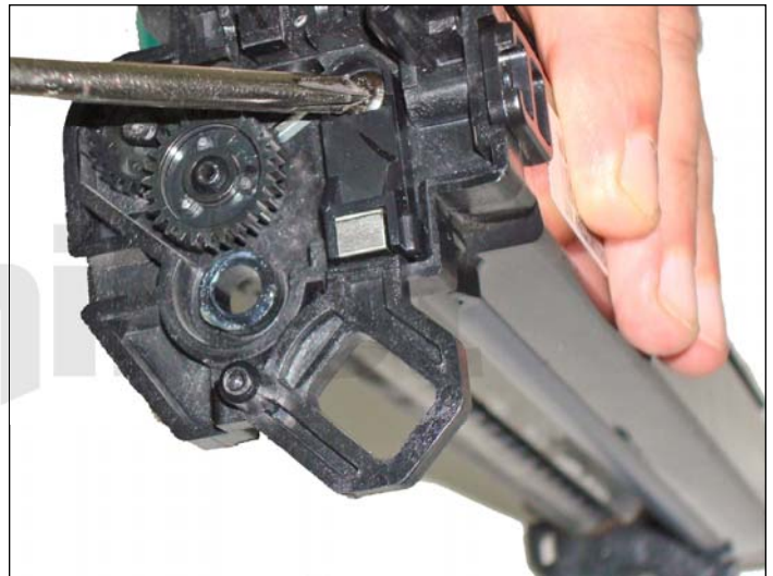
14. Sacar el tercer y ultimo tornillo de la tapa.
