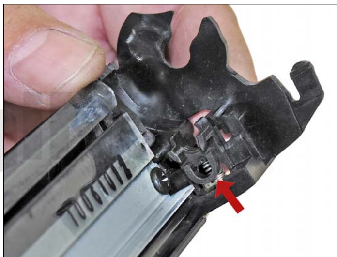
12. Remueva los dos soportes del PCR presionando las lengüetas en el fondo del soporte. Estos soportes necesitan ser removidos para tener acceso a la cuchilla limpiadora.
