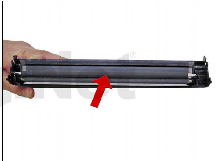
16. Coloque una pequeña cantidad de grasa conductiva en las bases e instale el PCR.
